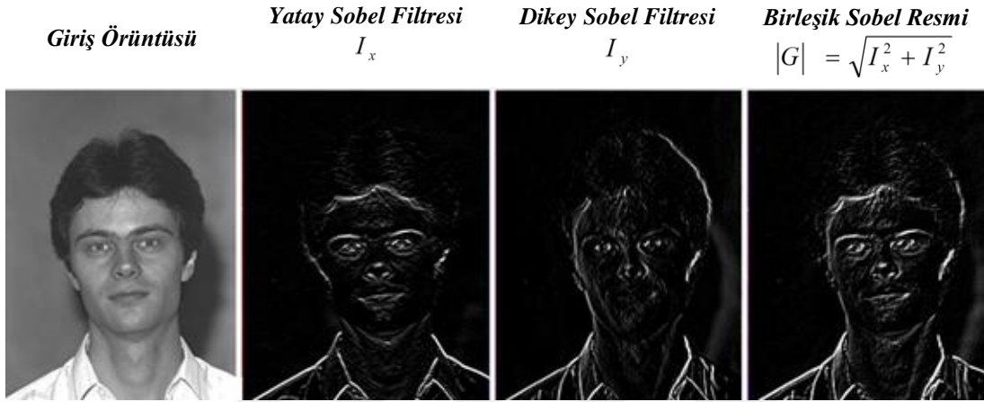
Resim 2.8: Orijinal giriş örüntüsü ve sobel filtrelerine ait çıktılar.
