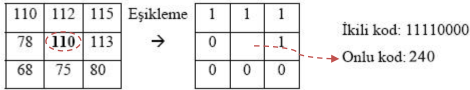
Şekil 2.3: LBP algoritması kullanılarak merkez pikselin etiketlenmesi.
