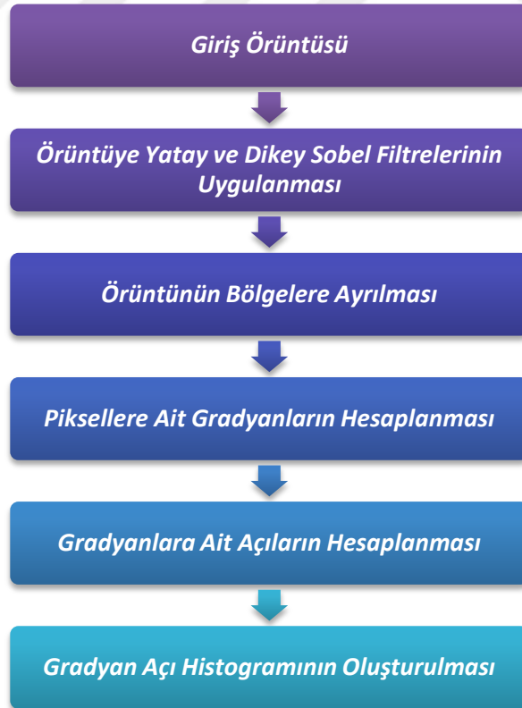
Şekil 2.5: HOG Algoritmasının çalışma diyagramı.
