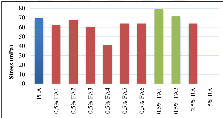
Şekil 5.6. PLA matrisli örneklerin çekme dayanımları
