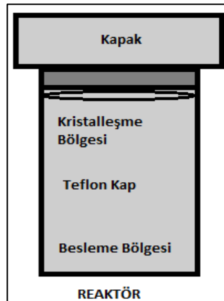
Şekil 3.2: Otoklav cihazının şematik gösterimi.
