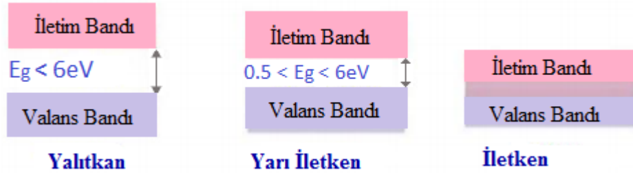
Şekil 1.6: Yalıtkan yarı iletken ve iletkenlerin tipik bant yapıları (Kittel, 1996).
