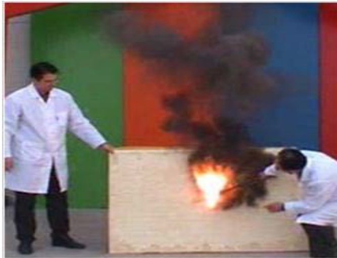
Şekil 2.4 Alev geciktirici katkılı ve katkısız yatak yanma testi
