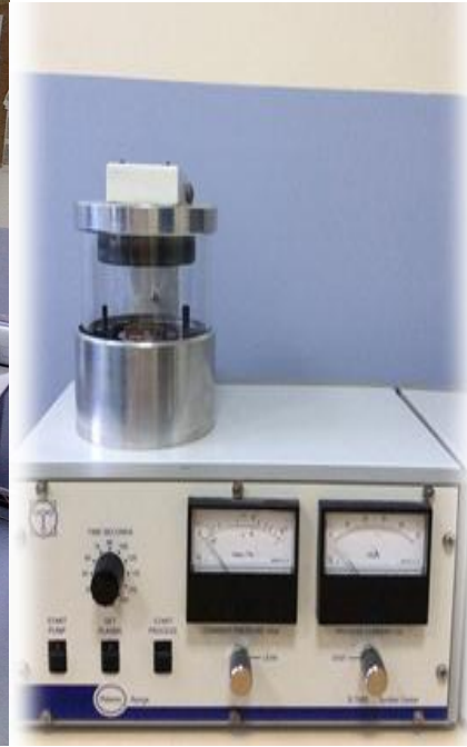
Şekil 5.9. JEOL-SEM ve Au-Pd kaplama cihazı.
