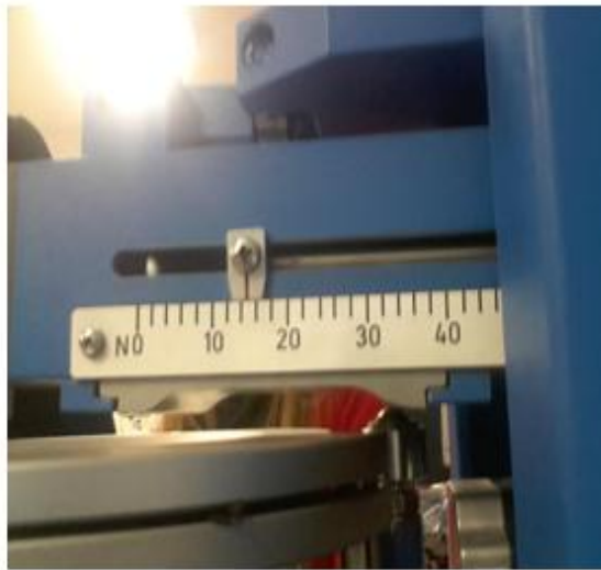
b) Çizik testi yük ayarlama kısmı.
