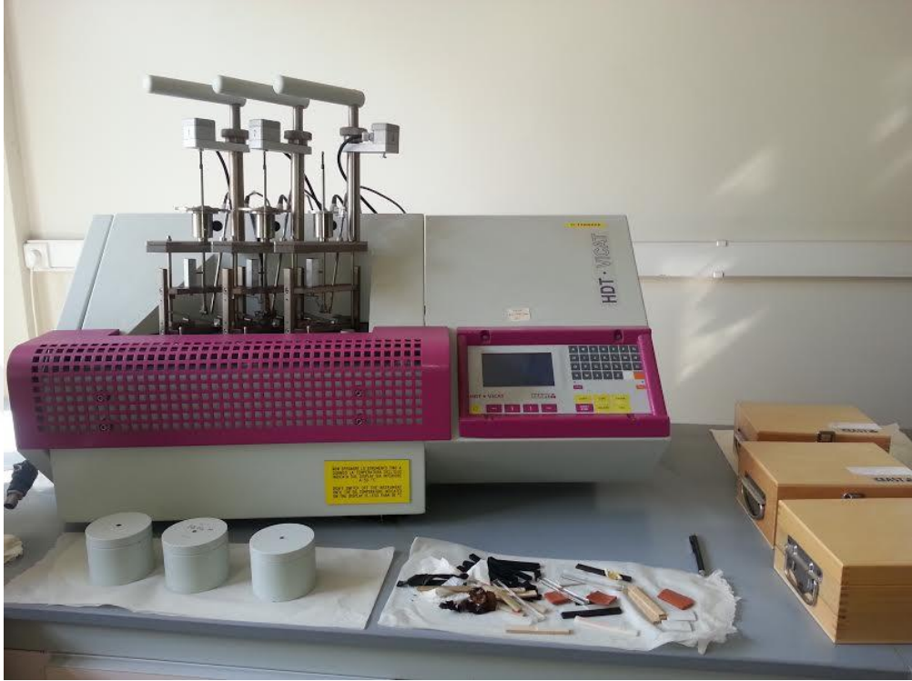
Şekil 5.4. HDT Test Cihazı-CEAST HDT Model.
