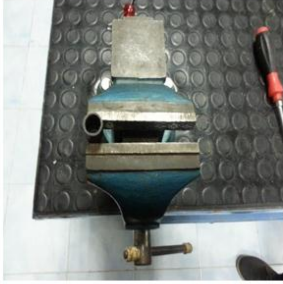
Şekil 5.8. SEM analizi için numune hazırlama ünitesi.
