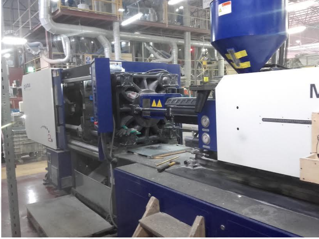
Şekil 5.2. Kullanılan enjeksiyon kalıplama makinası-HAITIAN MA 2000 model.
