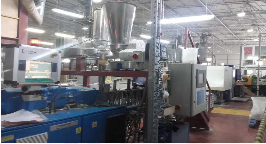
Şekil 5.1. Kullanılan ekstrüzyon makinesi, COPERION ZSK 26 MC model.
