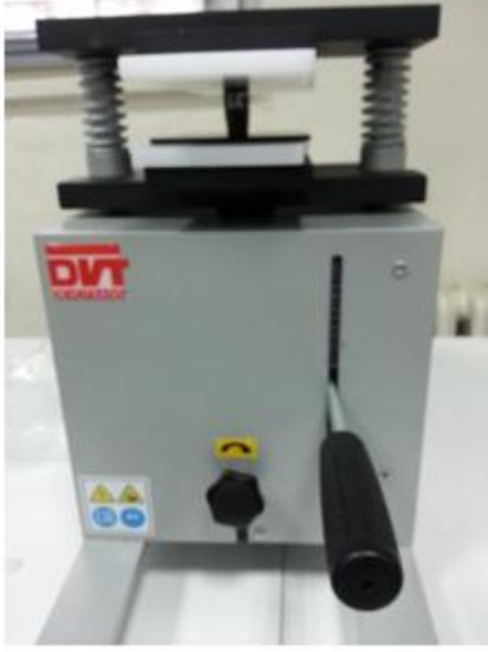
Şekil 5.8. SEM analizi için numune hazırlama ünitesi.
