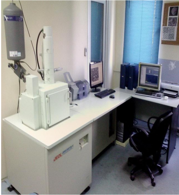
Şekil 5.9. JEOL-SEM ve Au-Pd kaplama cihazı.
