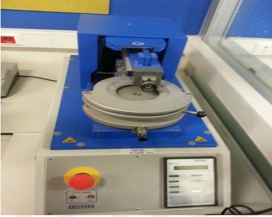
Şekil 5.5. Kullanılan 413 P-II ERICHSEN scratch hardness test cihazı.
