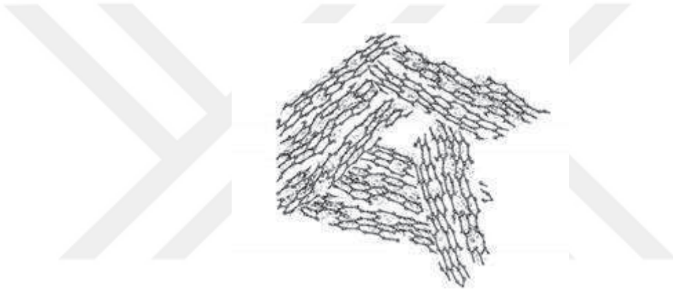
Şekil 2.26 : Turbostatik grafitin yapısı (Pierson, 1993).
