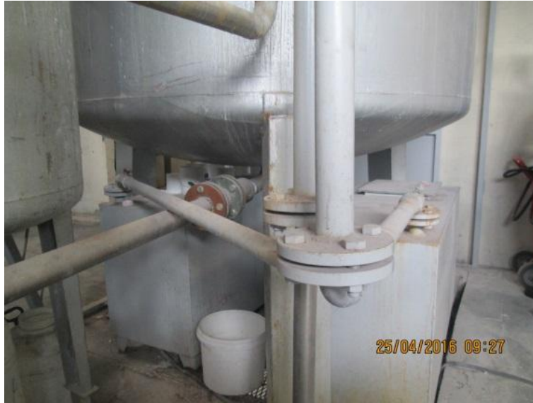
Şekil 7.5 : TK-201 de toluen ve TK-202 dikdörtgen depolama tankları
