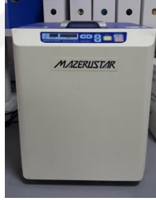
Şekil 6.2 Yüksek deformasyonlu planetary çalkalama ve karıştırma cihazı
