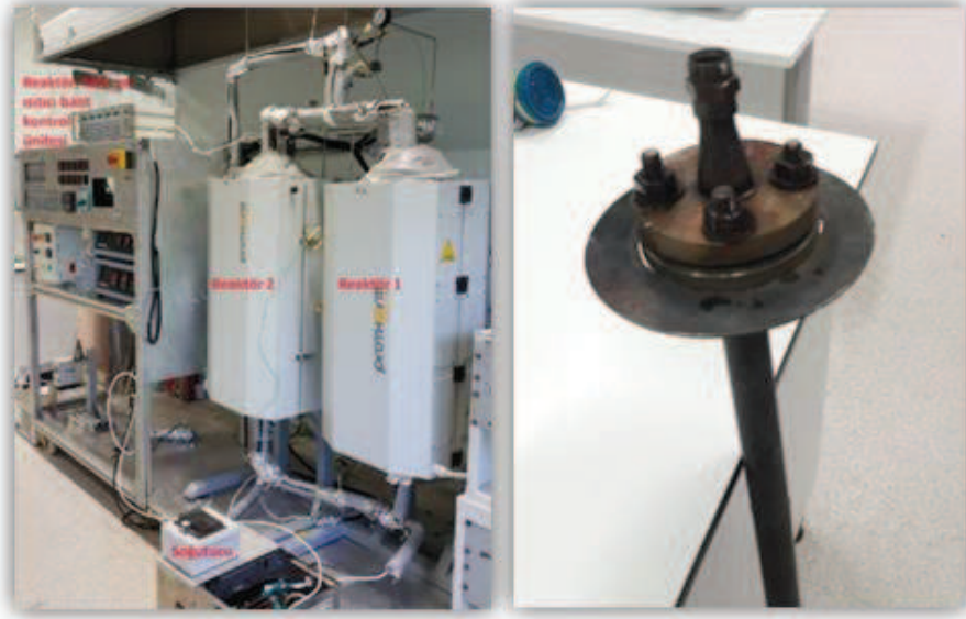
Şekil 4.5: a) Katran dönüşümü için kullanılan deney sisteminin görüntüsü b) Katalitik filtrenin içine yerleştirildiği tüp reaktör.
