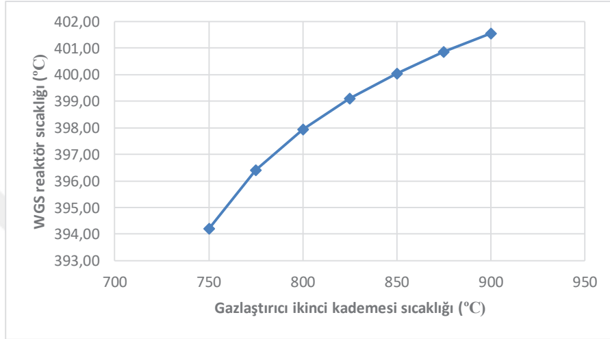
Şekil 5.15: Mısır atıkları simülasyonu gazlaştırıcı ikinci kademesi sıcaklığına bağlı WGS reaktör sıcaklığı değişimi.
