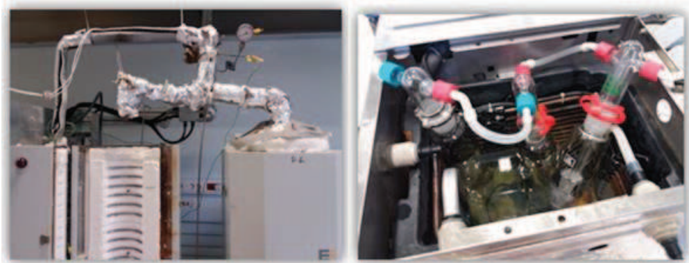
Şekil 4.6: a) Katran dönüşümü deney sistemi reaktör bağlantı hatları gösterimi b) Katran dönüşümü deney sisteminde su banyosu ünitesinin gösterimi.
