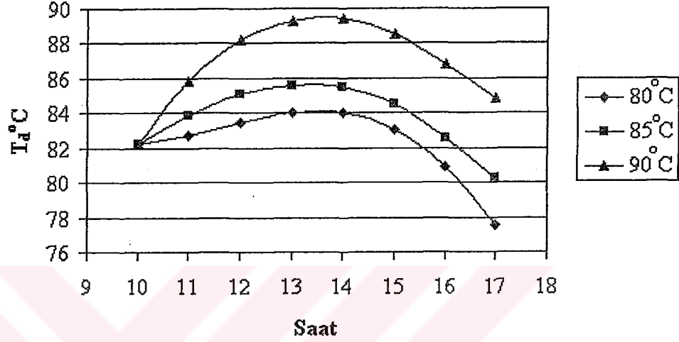
Şekil 4.9. Haziran ayında, gün içinde referans sıcaklığa bağlı olarak depo sıcaklığının değişimi
