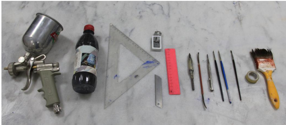
Resim 84; Sgraffito tekniğinde kullanılan başlıca malzemeler.
