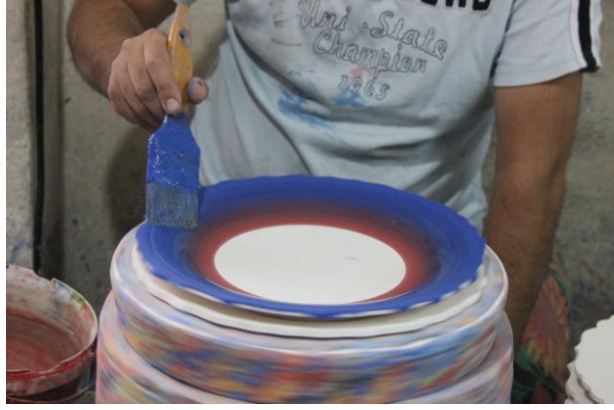
Resim 118; Bisküvi Ürün üzerine renkli sır altı boya ların yan yana ve üst üste sürülmesi
