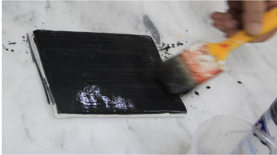
Resim 86; Deri sertliğindeki yağ çamur üzerine astarın fırça ile uygulanması
