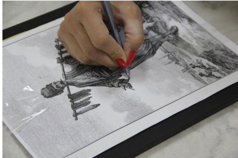
Resim 93; Boyanmış bisküvi ürün üzerine desenin renkli karbon kâğıdı ile aktarılması
