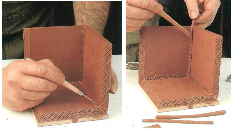
Resim 95, Levha Yöntemi ile Seramik Şekillendirme 4.aşaması, (Jordi Vigué,La Poteire, s.13)
