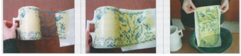
Resim 161, İndirek baskı yöntemi uygulaması,
