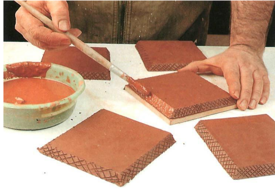
Resim 94, Levha Yöntemi ile Seramik Şekillendirme 3. aşaması (Jordi Vigué,La poteire, s.13)
