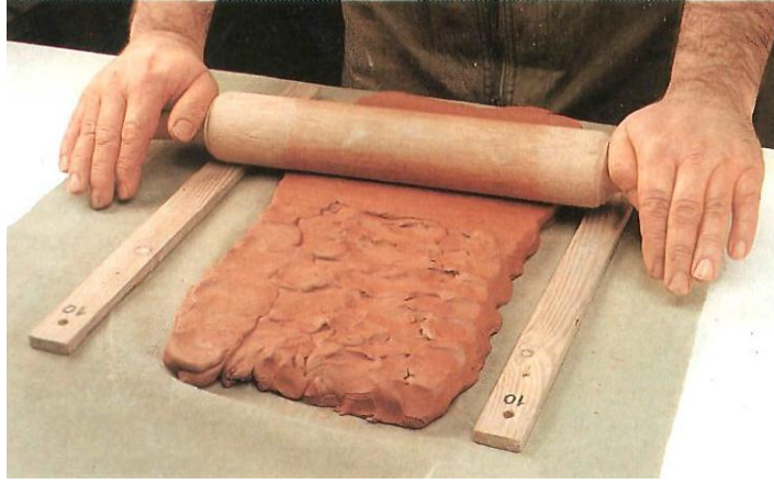
Resim 93, Levha Yöntemi ile Seramik Şekillendirme 2. aşaması , (Jordi Vigué, La Poteire, s.13)
