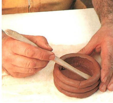
Resim 90, Sucuk Yöntemi ile Seramik Yapma 4. aşama
