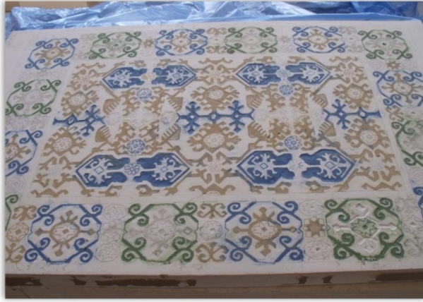
Resim 209, Alçı kalıbın renkli astarla doldurulması aşaması
