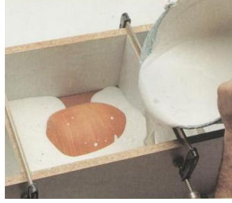
Resim 104, Sıvı (Döküm) Çamuru ile Seramik Şekillendirme 2. aşaması ,
