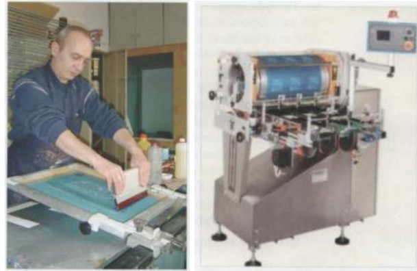
Resim 160, Elek baskı uygulaması el ile ve elek baskı makinesi,
