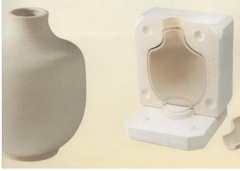
Resim 107, Sıvı (Döküm) Çamuru ile Seramik Şekillendirme 5. aşaması, (Jordi Vigué, La poteire, s.13)
