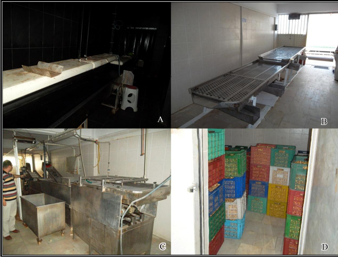
Foto 97. A.) Alfatoksinli İncirlerin Ayrılmasında Karanlık Odada Mor Ötesi Işık Kullanılmaktadır. B.) Tesislere Gelen İncirler Eleklerden Geçirilerek Boylarına Göre Ayrılmaktadır. C.) İncirlerin Yıkandığı Ünite. D.) İncirler Kurtlanmamaları İçin Fümigasyon İşlemine Tabi Tutulmaktadır.
