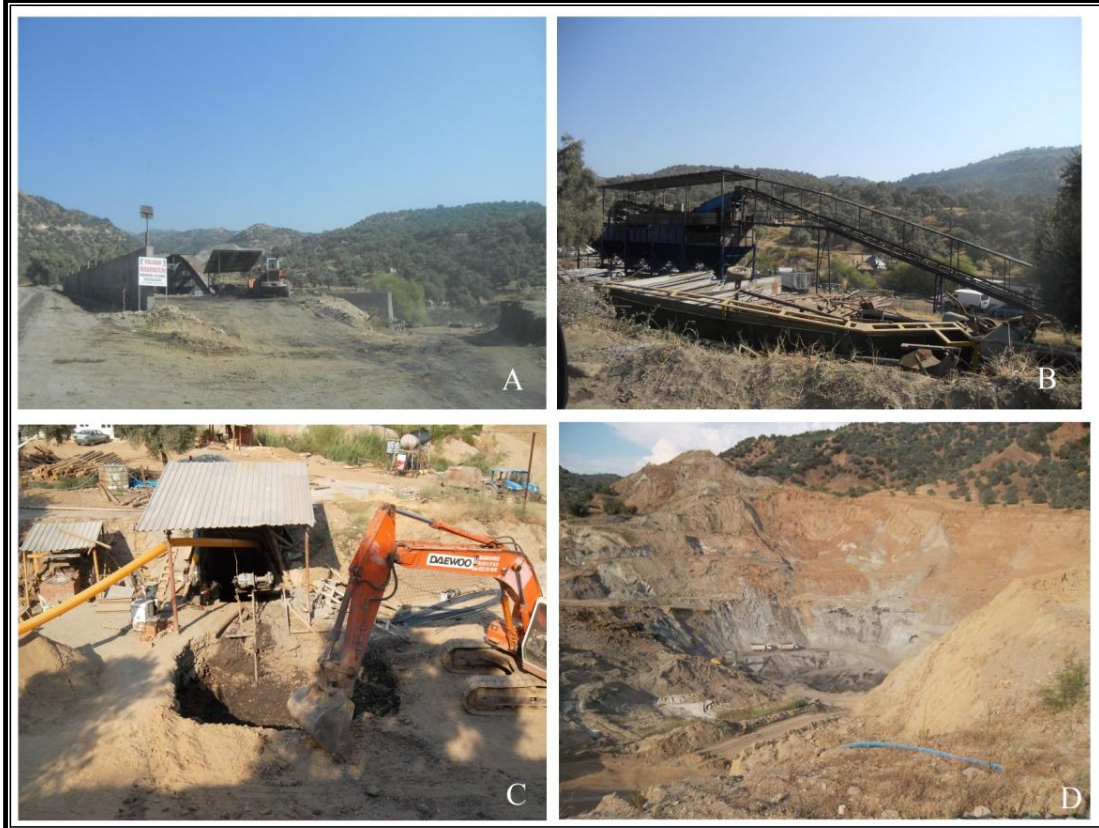
Foto 90. Ocaklı (Gereniz) Köyü Ocaklarından Görüntüler: A-B Eleme Ünitesi, C İşletmeye Ait Kapalı Ocağın Galeri Girişi, D Açık İşletme.
