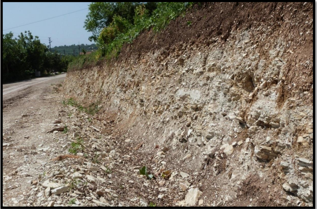
Fotoğraf 2. Kuzuluk Mevkinde Killi Kireçtaşı ve Marn Ardalanması (18.05.2013)
