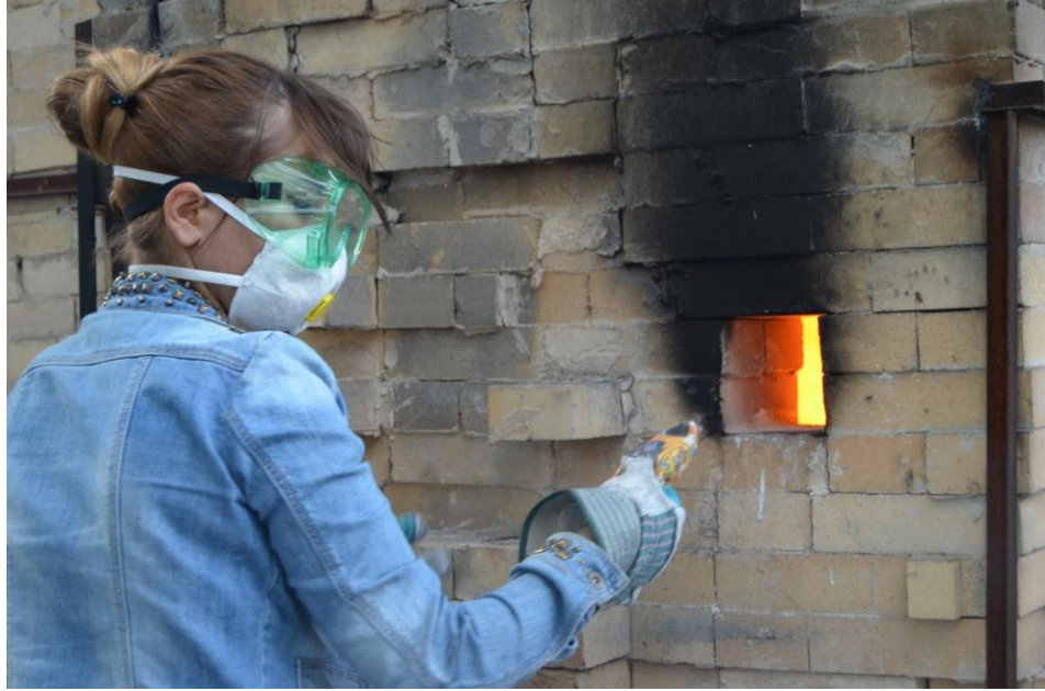
Resim 34; Soda Paketlerinin Fırına Verilmesi Fotoğraf: Mustafa SİR
