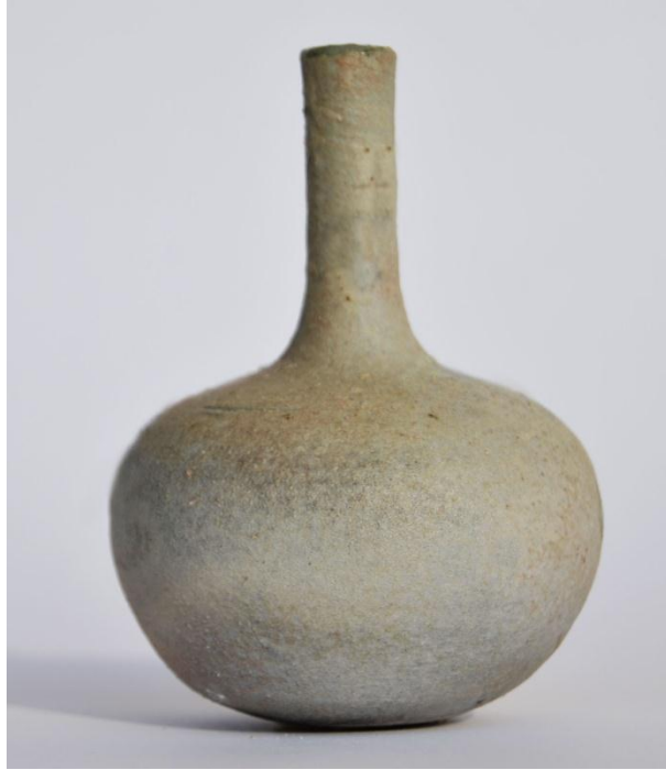
Resim 43; B.I. Nolu Astar Denemesi + Bakır Karbonat Fotoğraf: Sitem YILMAZ
