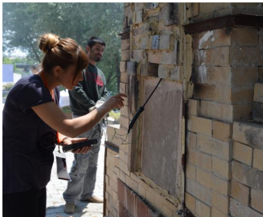
Resim 28; Ölçümün Dijital Termo Couple İle Yapılması Fotoğraf: Mustafa SİR
