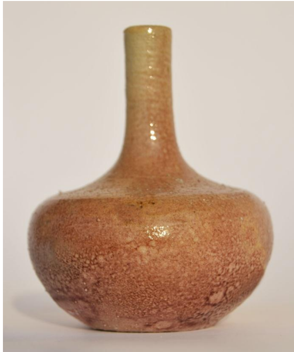
Resim 61; B.V. Nolu Astar Denemesi + Mangan Oksit Fotoğraf: Sitem YILMAZ
