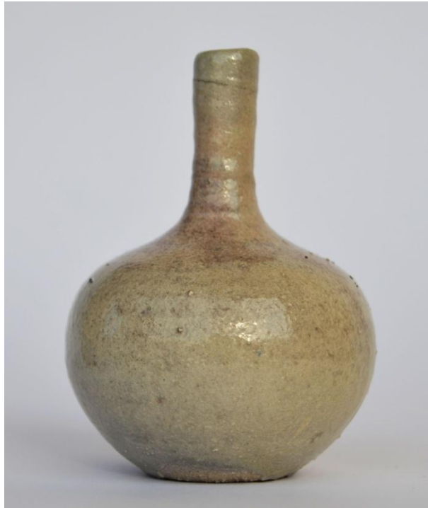
Resim 66; A.VII. Nolu Astar Denemesi + Bakır Karbonat Fotoğraf: Sitem YILMAZ
