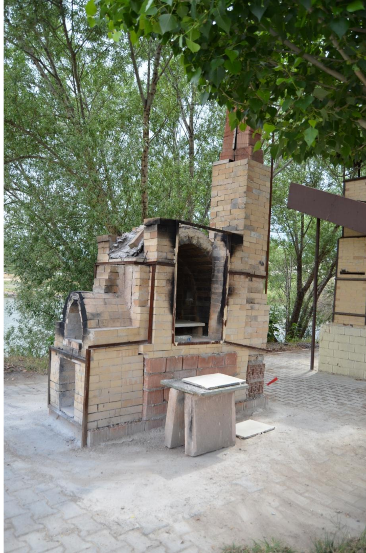
Resim 16; Tez Kapsamında Kullanılan Odun Yakıtlı Soda Fırını Fotoğraf: Mustafa SİR
