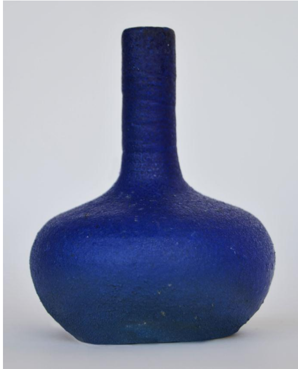
Resim 64; B.VI. Nolu Astar Denemesi + Kobalt Oksit Fotoğraf: Sitem YILMAZ
