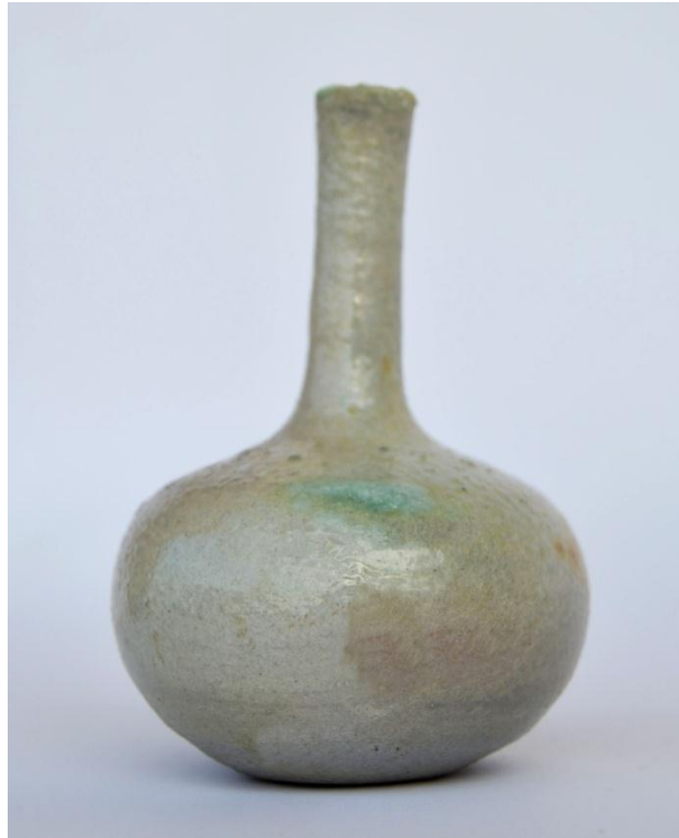
Resim 67; B.VII. Nolu Astar Denemesi + Bakır Karbonat Fotoğraf: Sitem YILMAZ
