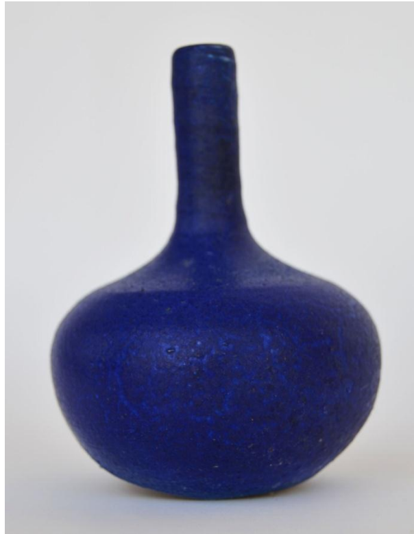
Resim 65; C.VI. Nolu Astar Denemesi + Kobalt oksit Fotoğraf: Sitem YILMAZ
