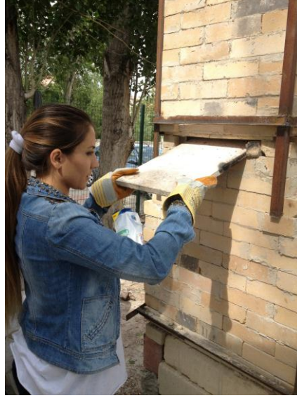
Resim 27; Fırın Baca Kapaklarını Bir Süreliğine Kapatarak İdirgen Ortam Sağlanması Fotoğraf: Mustafa SİR
