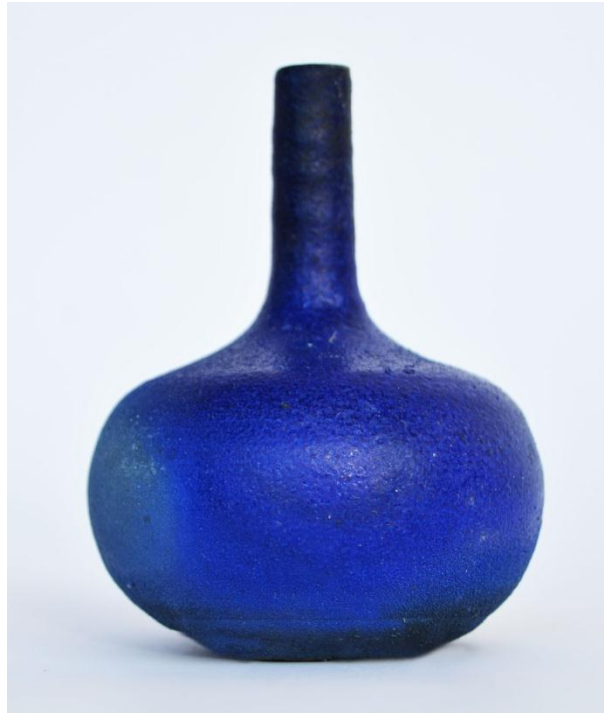
Resim 63; A.VI. Nolu Astar Denemesi + Kobalt Oksit Fotoğraf: Sitem YILMAZ
