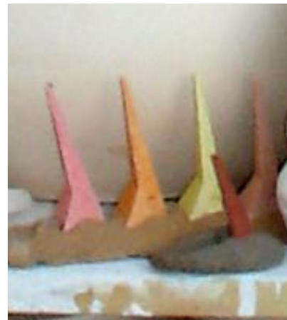
Resim 29; Ölçümleri Yapmak İçin Fırın İçerisine Yerleştirilen Seger Pramitlerini Fotoğraf: Mustafa SİR
