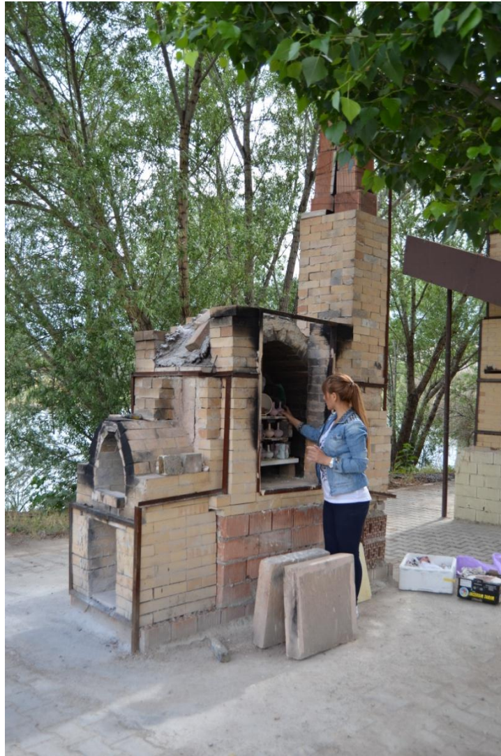
Resim 17; Seramiklerin Fırına Dizilmesi Fotoğraf: Mustafa SİR
