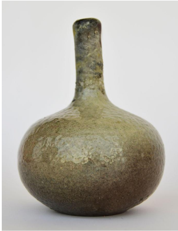
Resim 68; C.VII. Nolu Astar Denemesi + Bakır Karbonat Fotoğraf: Sitem YILMAZ
