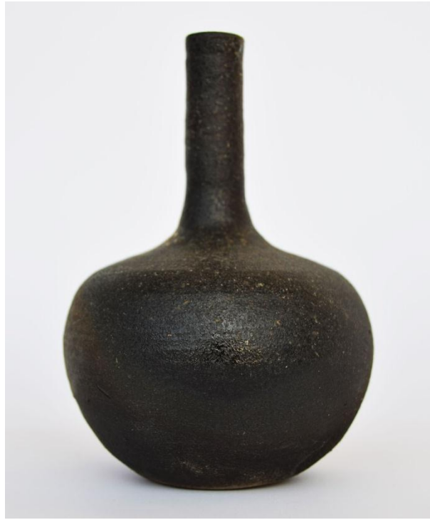
Resim 59; C.IV. Nolu Astar Denemesi + Demir Oksit Fotoğraf: Sitem YILMAZ
