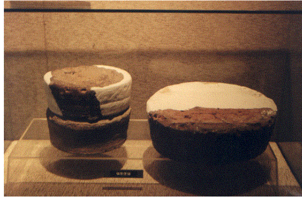
Resim 10; Çin’de Seledon Sırlı Ürünlerin Pişiriminde Kullanılan Sagar Kutuları.
