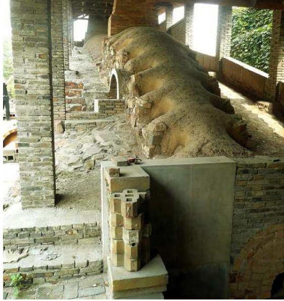
Resim 12; Çinde pişirmede kullanılan fırın içerisine yerleştirilmiş sagar kutuları ve fırını (Hange hou Müzesi-Çin)
