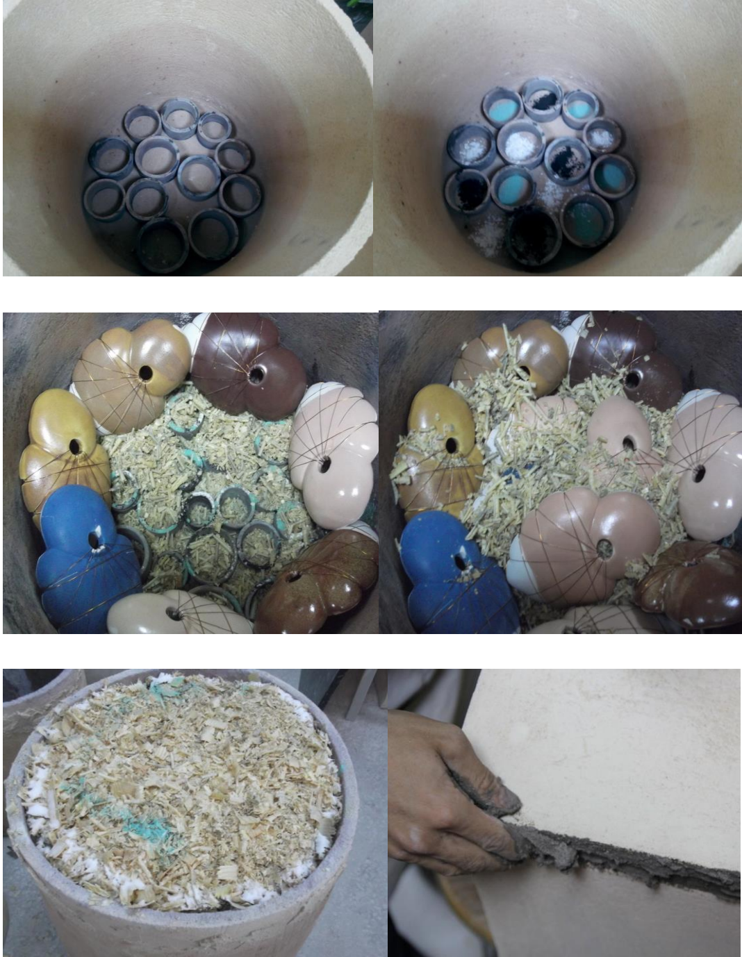
Resim 34; Plakaların sagar kutusuna yerleřtirilme ařamaları
