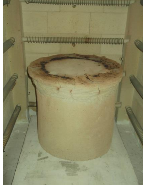
Resim 32; Elle şekillendirme, Şamot çamuru ile yapılmış sagar kutuları
