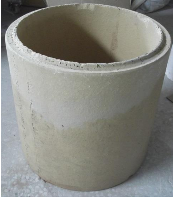
Resim 32; Elle şekillendirme, Şamot çamuru ile yapılmış sagar kutuları
