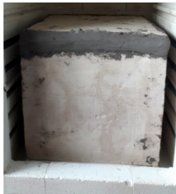
Resim 133. Sagar kutusunun fırına yerleştirilmesi.
