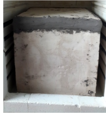
Resim 67. Sagar kutusunun fırına yerleştirilmesi.
