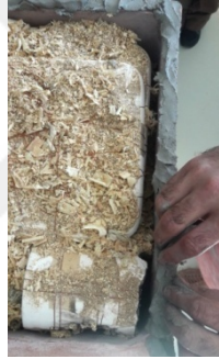
Resim 131. Sagar kutusunun ağız kısmının şamot ile sıvanması.
