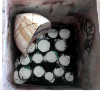
Resim 65. Seramik formların sagar kutusuna yerleştirilmesi.
