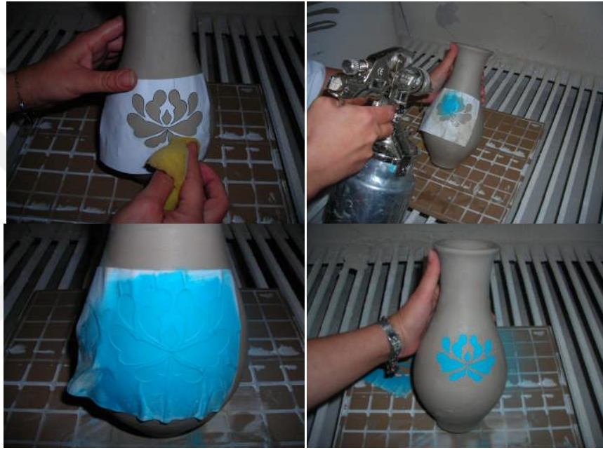
Resim 147: Deri Sertliğindeki Çamur Üzerine Şablon Dekor Uygulama Aşamaları
