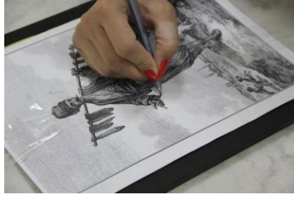
Resim 140: Boyanmış Bisküvi Ürün Üzerine Desenin Renkli Karbon Kâğıdı ile Aktarılması
