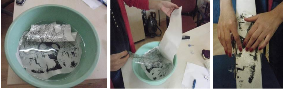
Resim 161: Bir Serigrafi Dekal Kağıttan Seramik Yüze Uygulanışı
