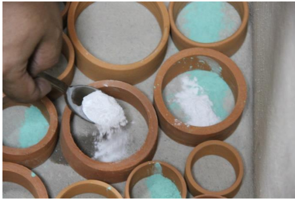
Resim 165: Sagar Kapsülünün Zeminine Yerleştirilen Tornalar İçine Çeşitli Oksitler, Karbonatlar, Nitratlar, Sülfatlar ve Tuzun Hazırlanması
