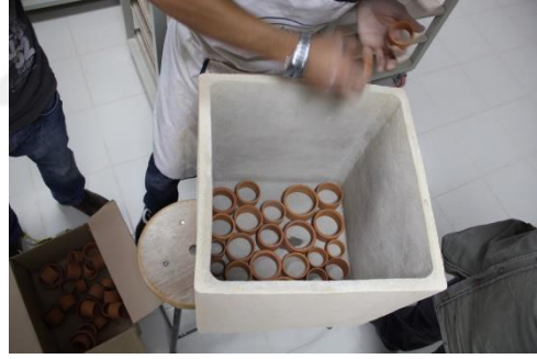
Resim 164: Sagar Kapsülünün İç Zemininin Hazırlanışı
