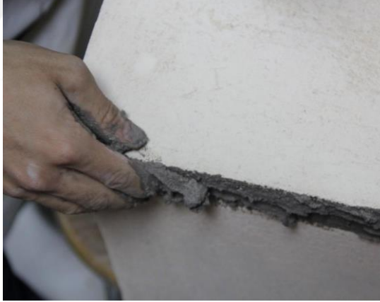
Resim 167: Sagar Kapsülünün Kapatılarak Balçık Çamurla Etrafının Sıvanması
