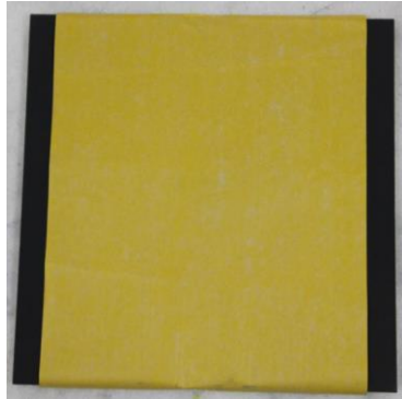
Resim 139: Boyanmış Bisküvi Ürün Üzerine Desenin Renkli Karbon Kağıdı Yerleştirilmesi
