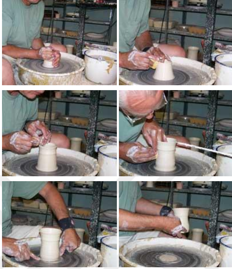
Resim 128: Çömlekçi Tornası ile Şekillendirme Örneği
