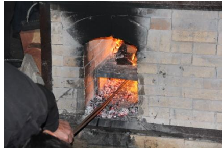
Resim 173: Organik Yanıcı Bir Madde Olan Odunla Tuz Fırınının Yakılması
