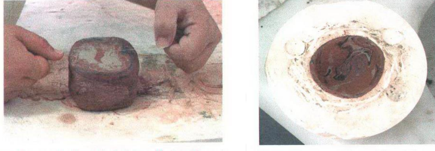
Resim 154: Hazırlanan Renkli Çamur Kütesinin Misina Yardımı ile Kesilip Kalıp İçine Basılması
