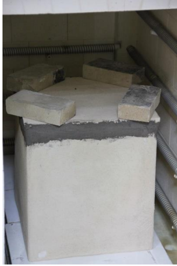
Resim 168: Sagar Kapsülünün Fırına Yerleştirilmesi
