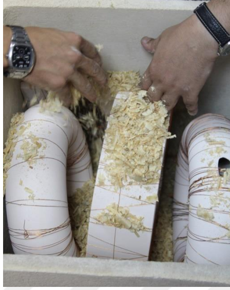
Resim 166: Sagar Kapsülünün İçine Önceden Bakır Tellerle Sarılarak Hazırlanmış Formların Kapsüle Yerleştirilmesi
