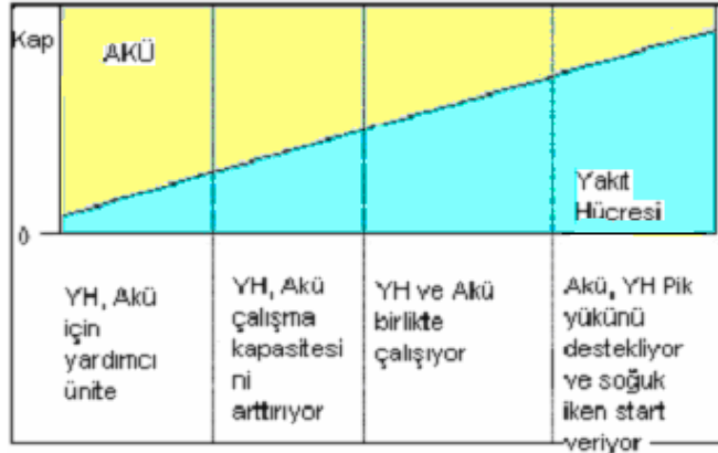
Şekil 3. 13. Hibrid Sistemin farklı çalışma durumları için Y.H., Akü kapasitesi arasındaki ilişki
