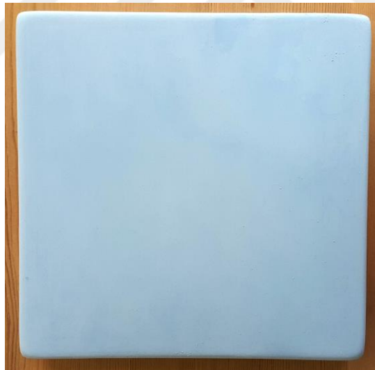
Resim 124; Renkli Döküm Tekniği ile Şekillendirilmiş Seramik Karo, Döküm Çamuru, Kalıp ile Şekillendirme, 20 x 4 x 20 cm.
