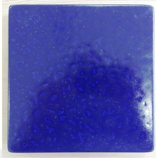
Resim 140; Kobalt Oksitli Sır ile Sırlanmış Seramik Karo, Döküm Çamuru, Kalıp ile Şekillendirme, 20 x 4 x 20 cm.
