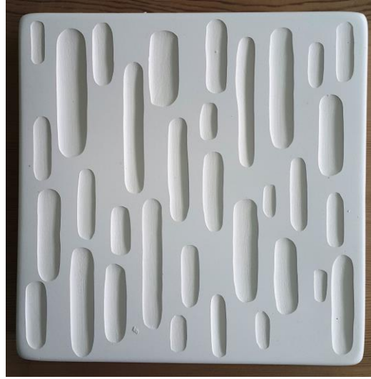
Resim 110; Bisküvi Pişirimi Yapılmış Parafin Oyma Tekniği ile Dekorlanmış Seramik Karo.
