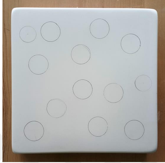
Resim 93; Parafin Uygulamasından Önce Seramik Karo Yüzeyine Ajur Tasarımının Çizilmiş Hali, Döküm Çamuru, Kalıpla Şekillendirme, 20 x 4 x 20 cm.
