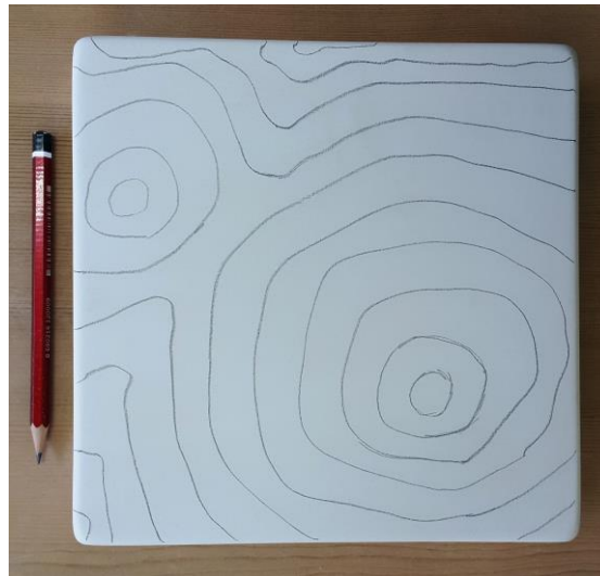
Resim 100; Parafin Uygulamasından Önce Seramik Karo Yüzeyine Kabartma Tasarımının Çizilmiş Hali, Döküm Çamuru, Kalıp ile Şekillendirme, 20 x 4 x 20 cm.
