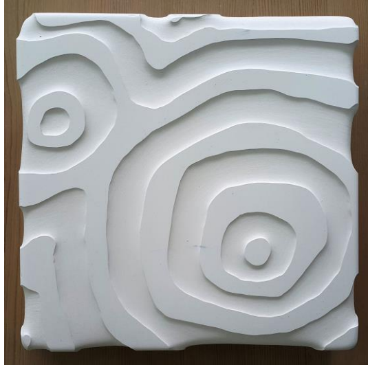
Resim 105; Bisküvi Pişirimi Yapılmış Parafin Kabartma Tekniği ile Dekorlanmış Seramik Karo.
