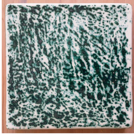
Resim 132; Sır Pişirimi Yapılmış Katı Parafin Tekniği ile Dekorlanmış Seramik Karo.
