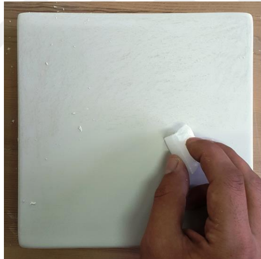
Resim 129; Deri Sertliđine Ulařmıř Seramik Karo Yzeyine Katı Parafin Uygulaması.
