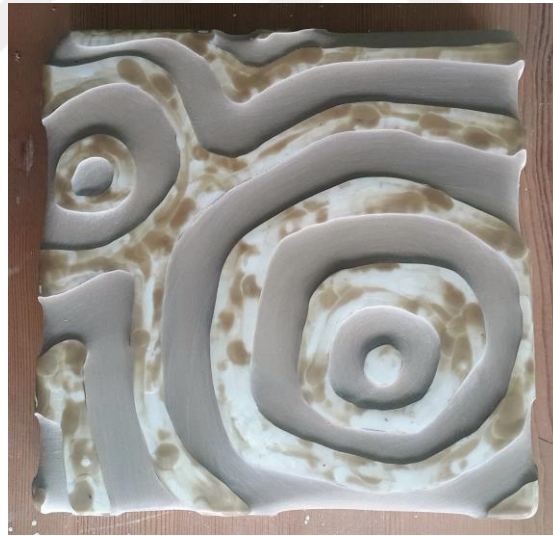
Resim 104; Parafin ile Kabartma Uygulaması Tamamlanmış Seramik Karo.
