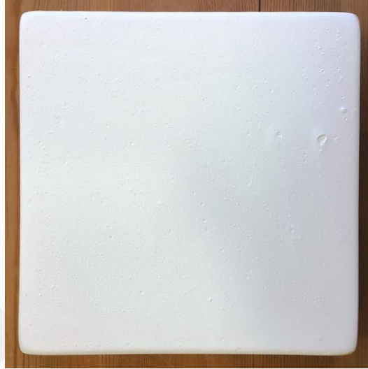
Resim 144; Opak Beyaz Sır ile Sırlanmış Fakat Pişirilmemiş Seramik Karo.
