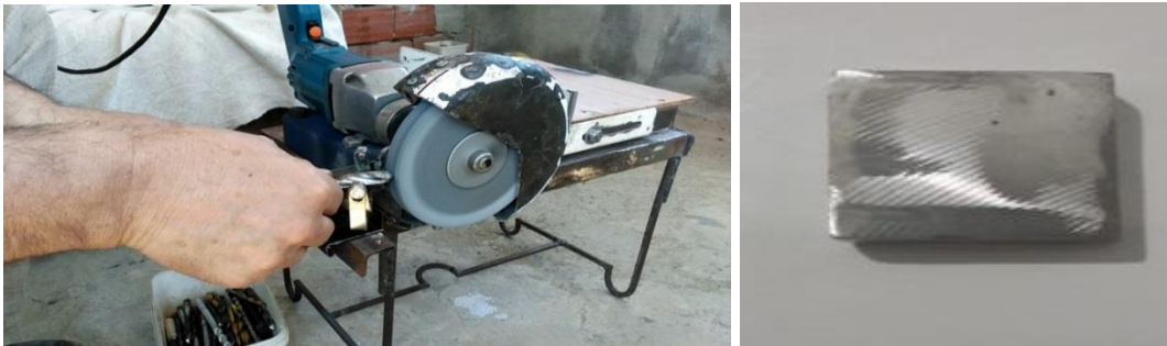
Şekil 30. Greyder bıçağından kesilen numune zımparalama işlemi ve incelemelere hazır numune görüntüsü.
