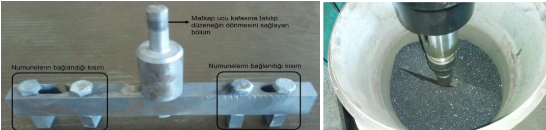
Şekil 35. Eroziyon aşınma deneyi düzeni
