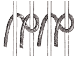
Çizim 9 İran (Sine) Düğümü
