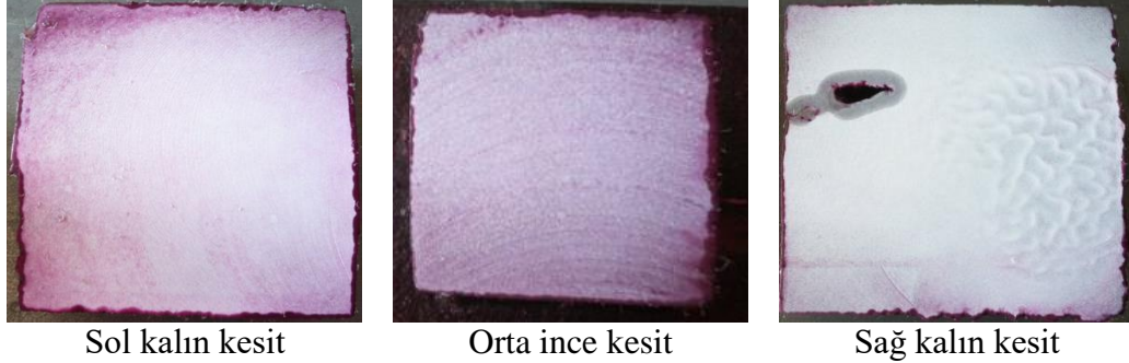
Şekil 49. Yaş kalıp kumda yan tek besleyicili numunelerin penetrant testi.
