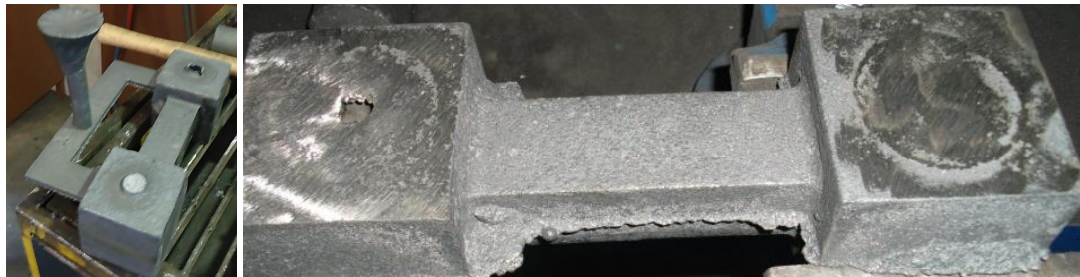
Şekil 40. Yaş kalıp kumu ile dökülmüş üst besleyicili boğaz bağlantı görüntüleri.
