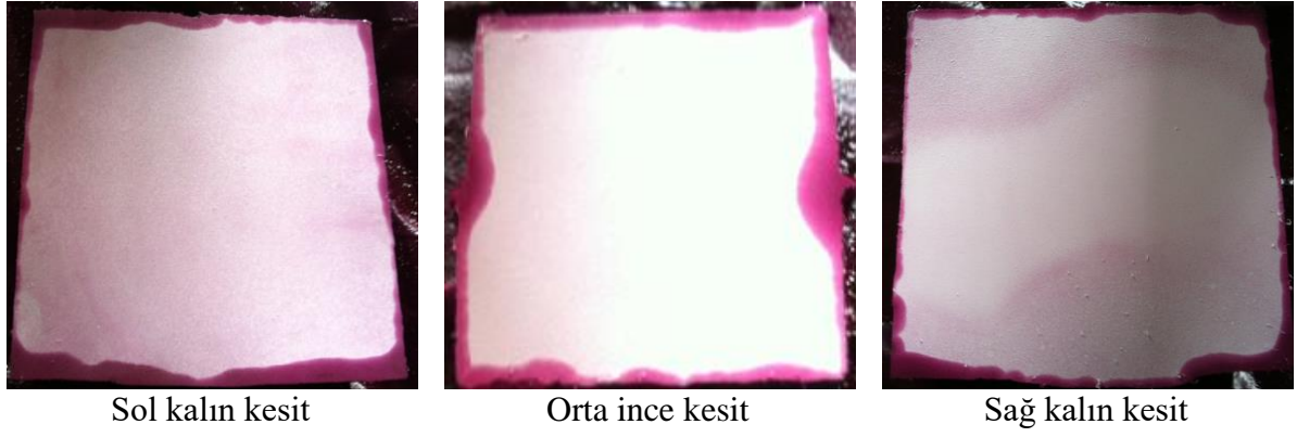
Şekil 55. Reçineli kalıp kumda yan çift besleyicili numunelerin penetrant testi.
