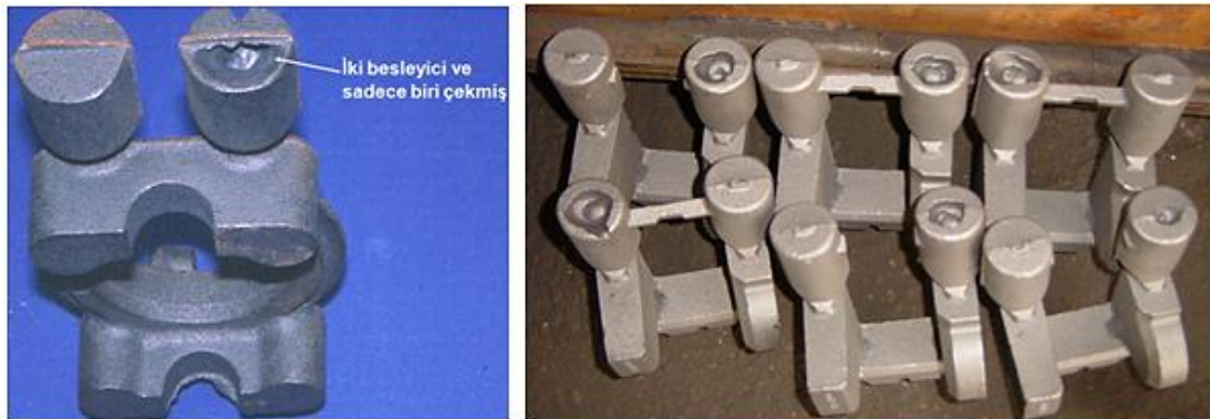
Şekil 11. Gereksiz besleyicilerin çekme yapmadığına ilişkin döküm örnekleri.
