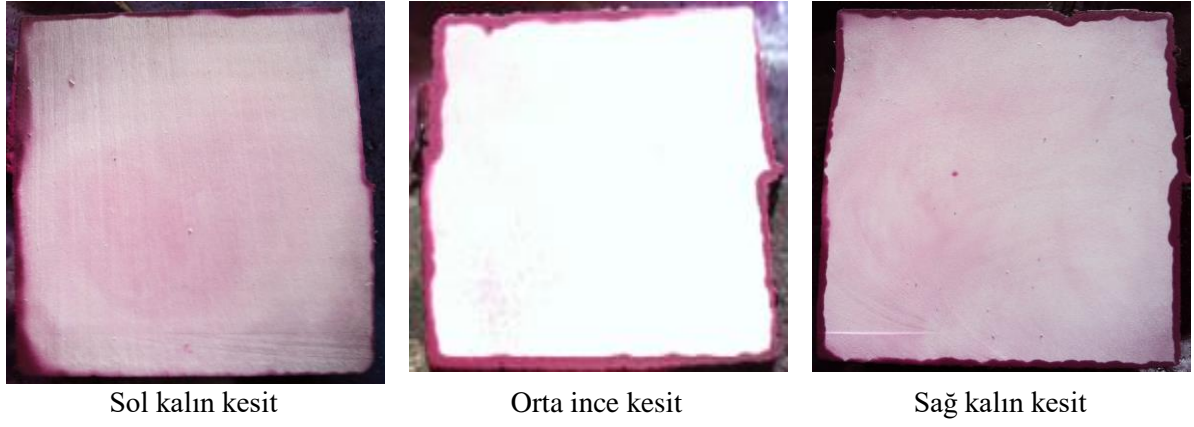
Şekil 53. Yaş kalıp kumda yan çift besleyicili numunelerin penetrant testi.
