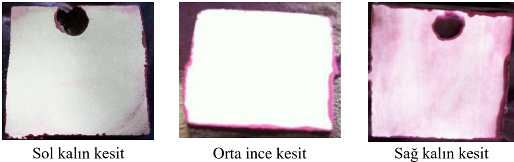
Şekil 61. Yaş kalıp kumda üst çift besleyicili numunelerin penetrant testi.
