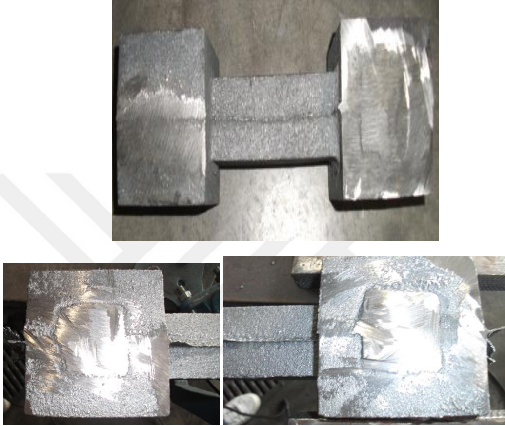
Şekil 38. Reçineli kalıp kumu ile dökülmüş besleyici boğaz bağlantı görüntüleri.
