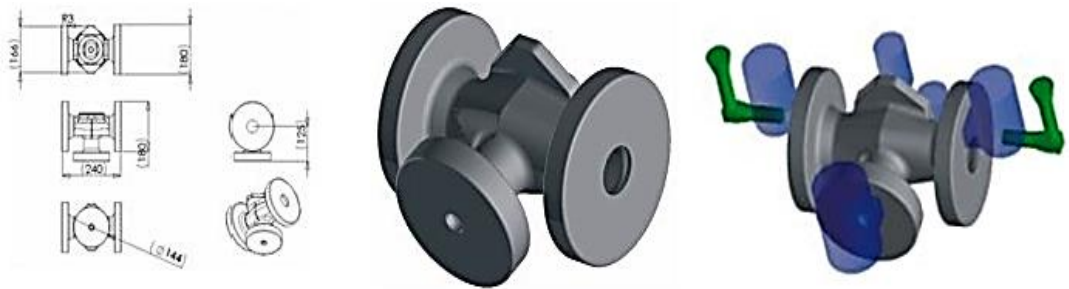
Şekil 5. Döküm parçanın modellenme aşamaları (Arda & Kayıkçı, 2006).
