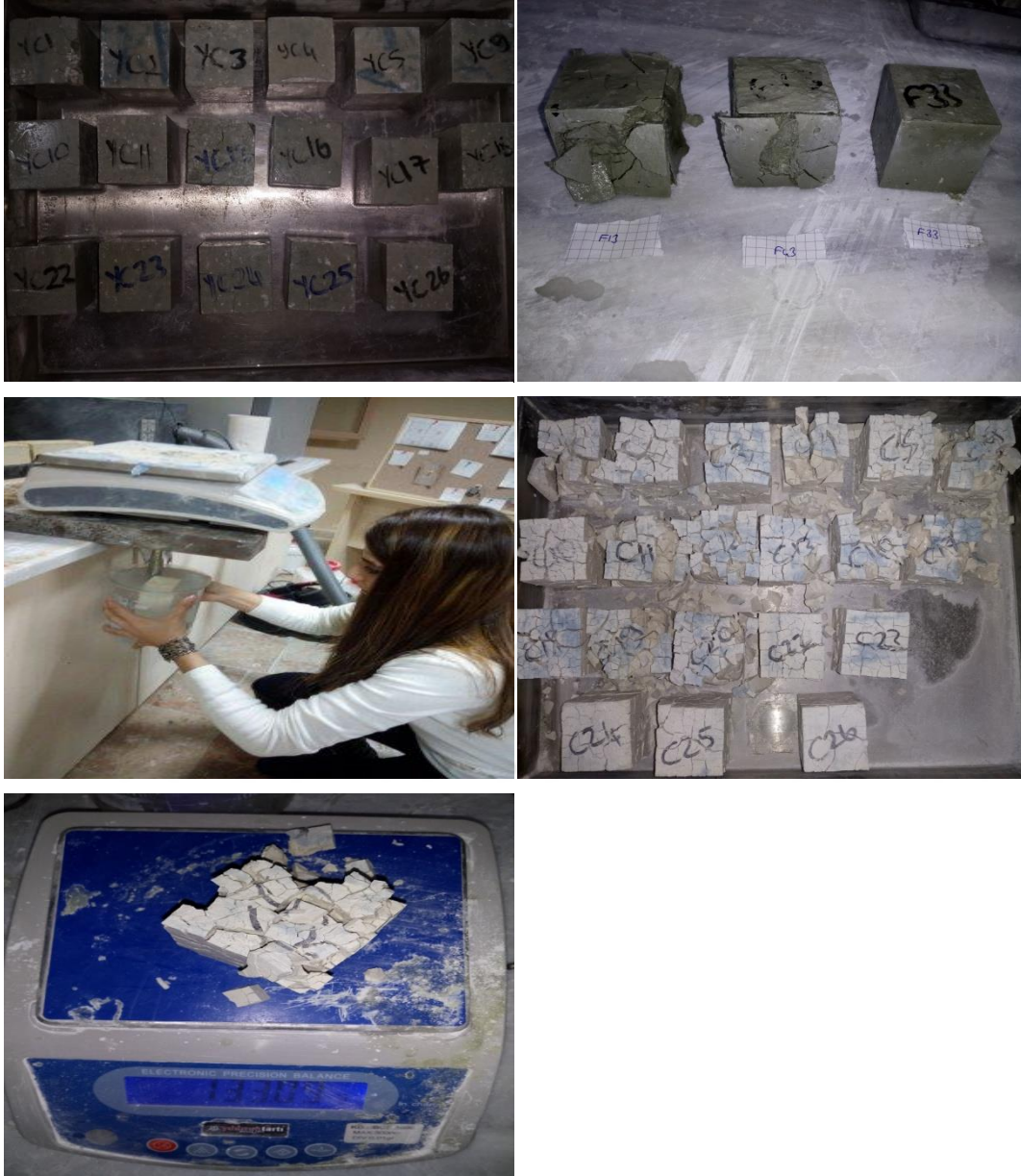
Őekil 5. 1:Ca(OH) 2 aktivatorl BYT hamurlarının su emme deneyi, 2:NaOH aktivatorl BYT hamurlarının etv sonrası durumu, 3: Su emme deneyinin yapılması, 4:Etv sonrası Ca(OH) 2 aktivatorl hamurların rtresi, 4:Tartım iŐlemi
