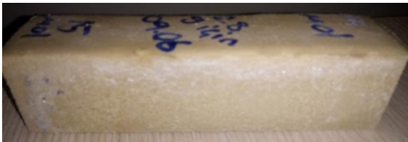
Şekil 14. 15 M derişimle üretilen hamurun dış yüzeyinde oluşan çiçeklenme
