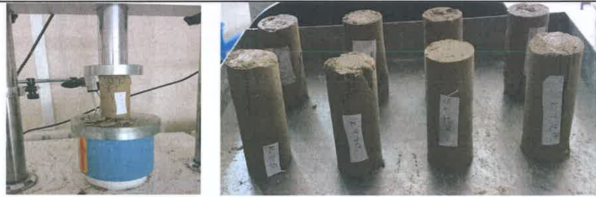
Şekil 36. Tek eksenli serbest basınç dayanım testi.
