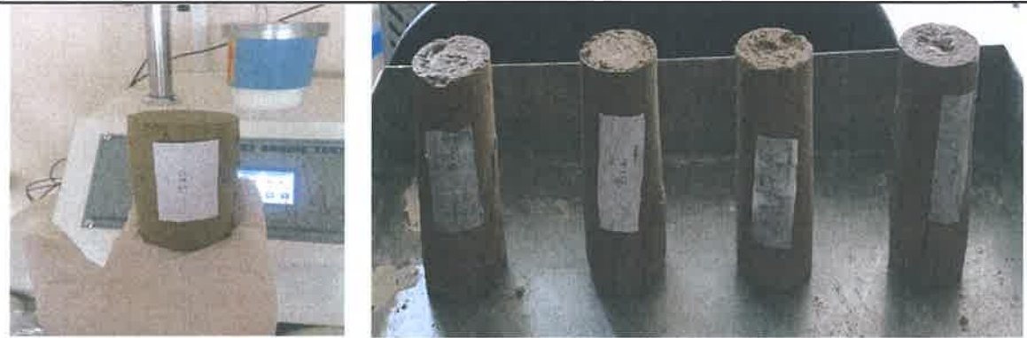
Şekil 37. Kireçli numunelerin serbest basınç dayanımı testi altındaki görüntüsü.
