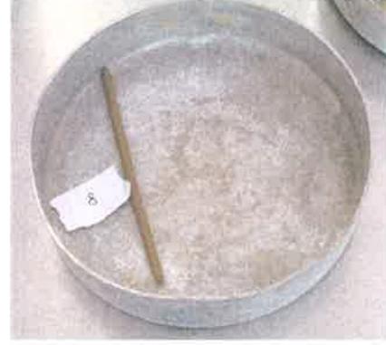
Plastik limit için hazırlanan 3 mm çapındaki silindirik numune
