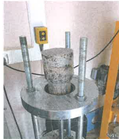
Yapısal bütünlüğünü kaybetmeden kalıptan çıkarılması
