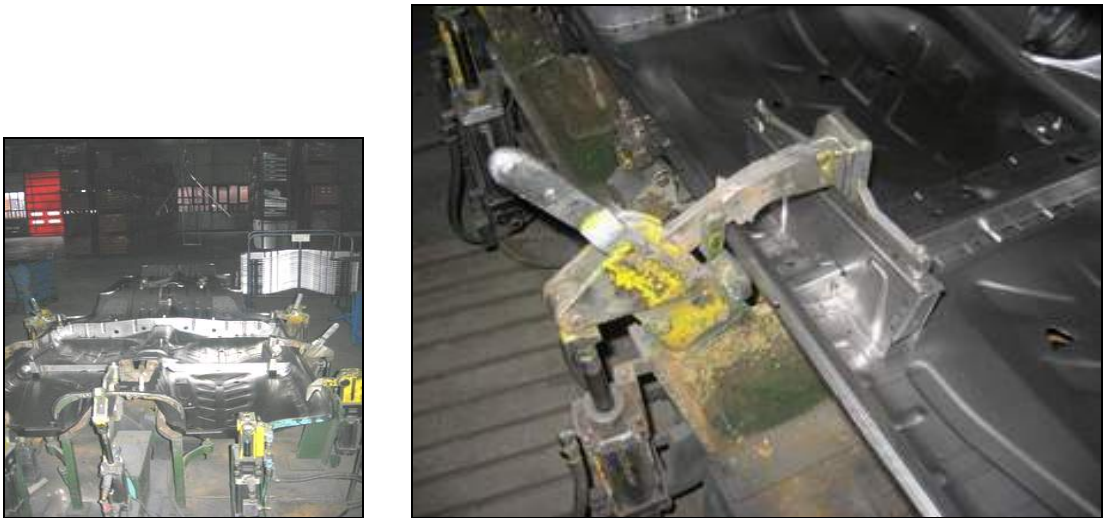
Örnek 2.20 Şahin Doğan orta taban toplama aparatı
