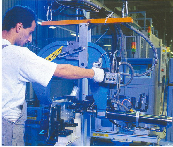
Şekil 2.45. Sabit bileşen sisteminde kendinden delmeli sistemin manueli ( www.boellhoff.de , 2006)
