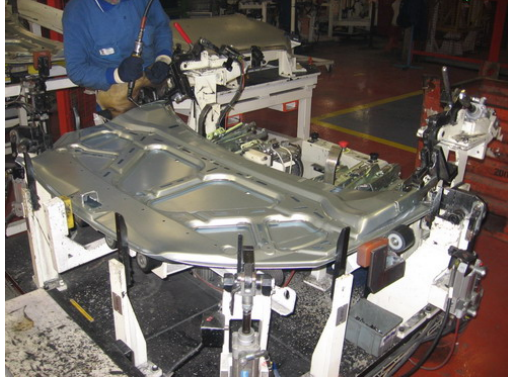
Şekil 2.68 Kaput 90° kenetleme presi ve kalıbı, punta tamamlama ve menteşe takma prosesi
