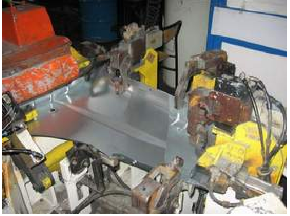
Şekil 2.22. Doblo çamurluk toplama aparatı
