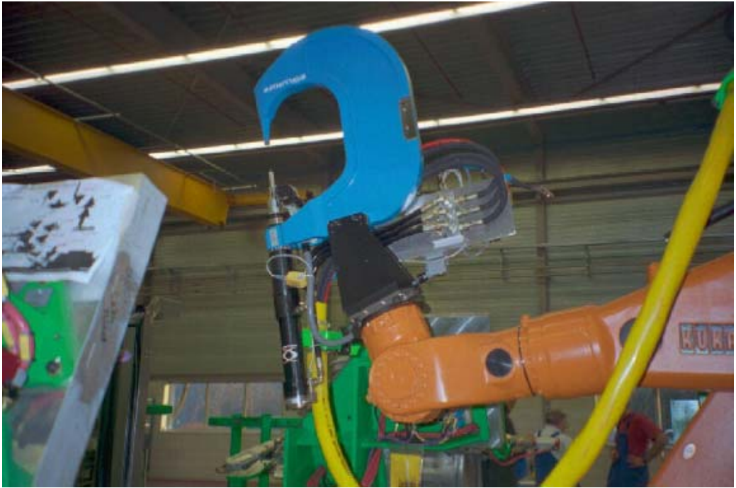
Şekil 2.46. Robot kendinden beslemeli tam otomatik üretim hattında otomatik taşıma ( www.boellhoff.de , 2006)
