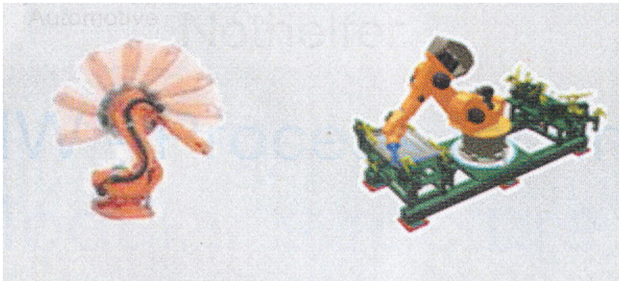
Şekil 3.5. Hemming robot ve fikstürü ( http://www.thyssenkrupp.com , 2006)
