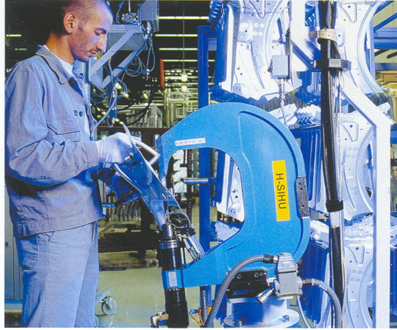
Şekil 2.43. Manuel bileşen taşıma statik kendinden delmeli perçin sistemi ( www.boellhoff.de , 2006)
