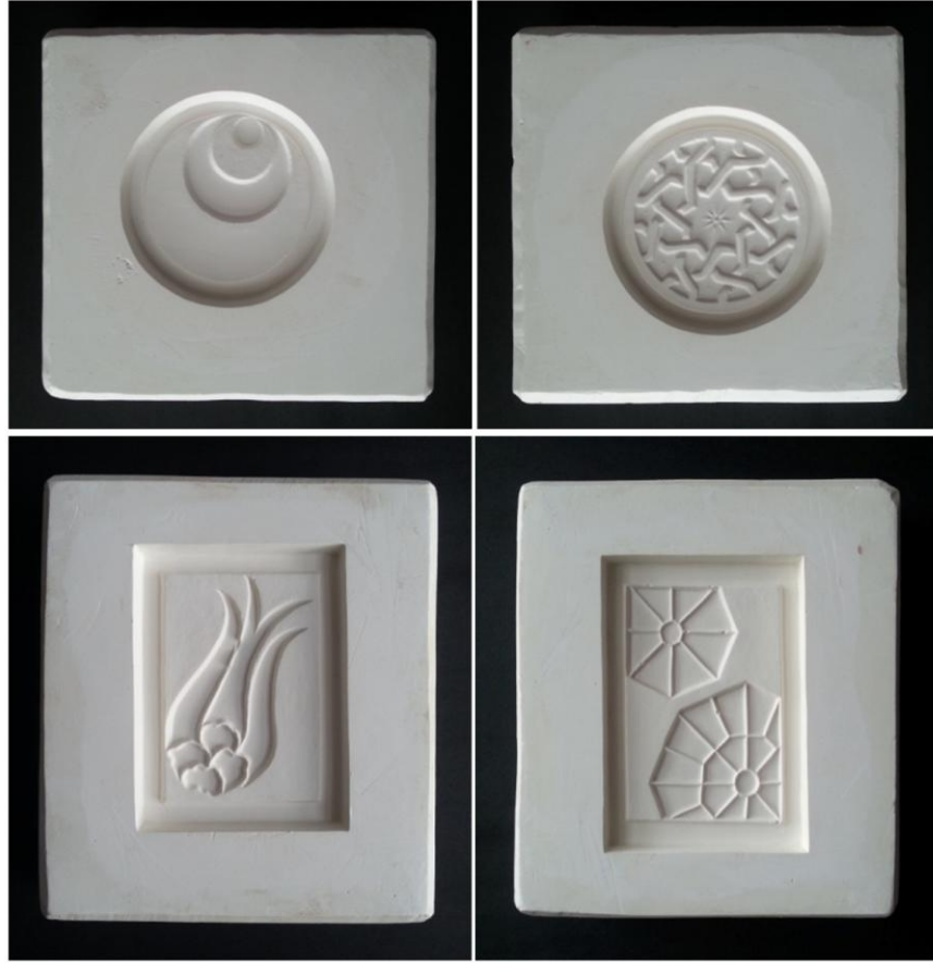
Şekil 9. Tasarımı yapılan modellerin kalıpları
