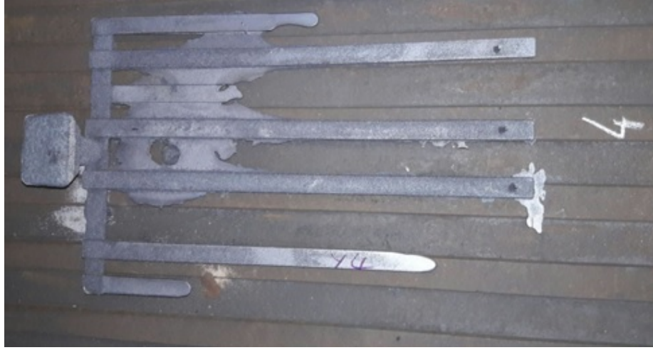
Şekil 26. Döküm sonrası akıcılık kanallarının birleşmesi hatası görünümü.
