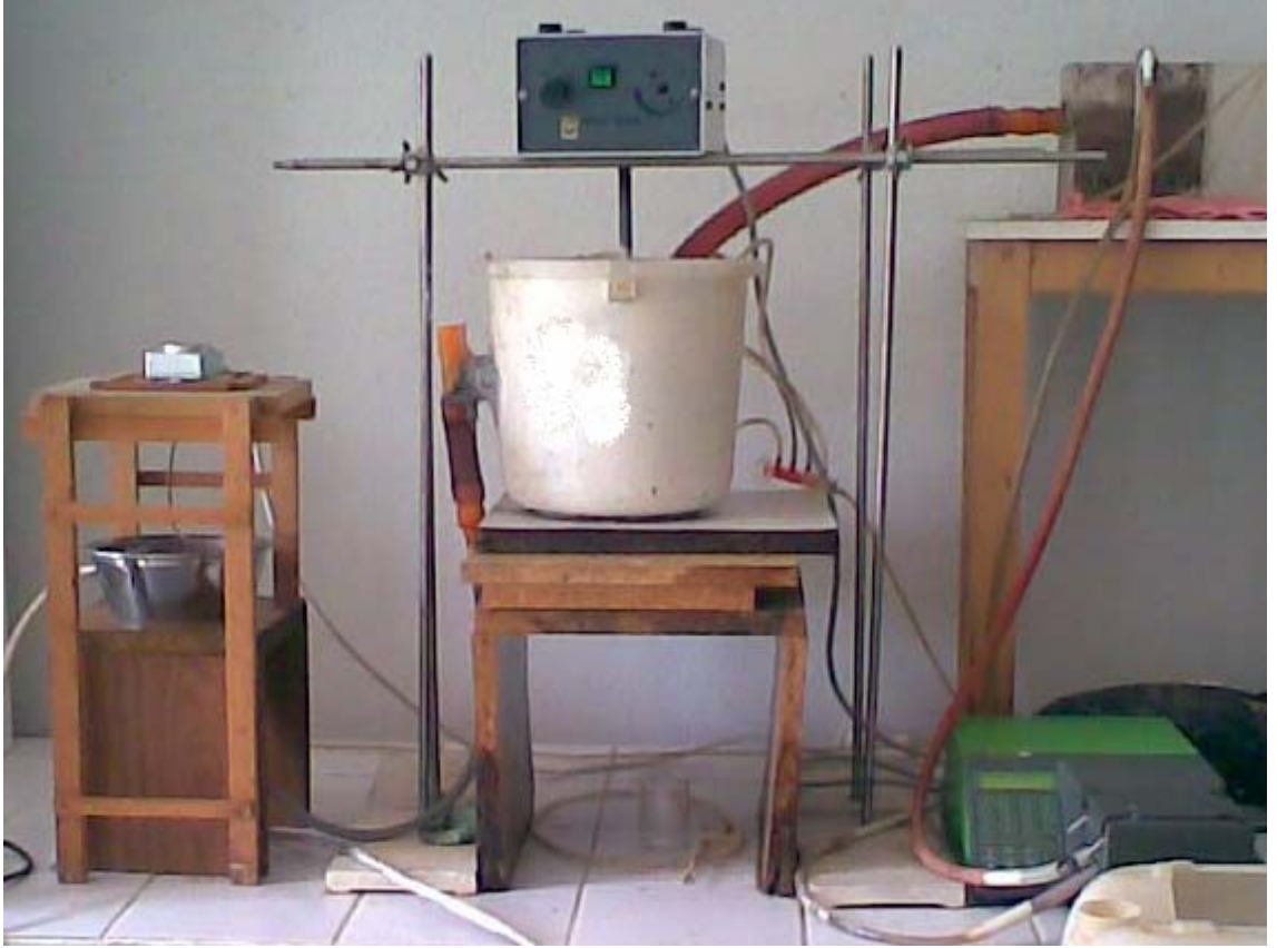
Şekil 3.4. Laboratuvar ölçekli aerobik seçicili aktif çamur sistemi
