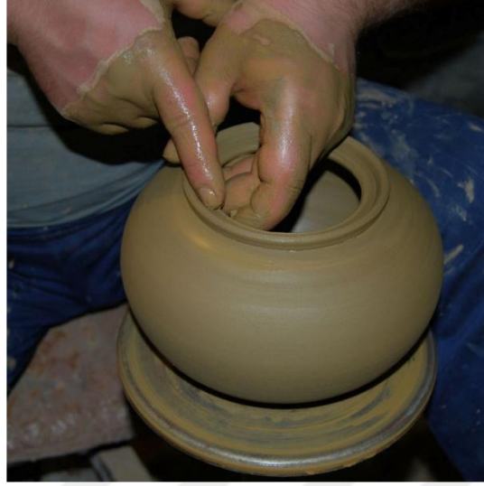
Resim 48: Kapağın oturacağı yuva Kaynak: Fotoğraf Hakan ÖCEL
