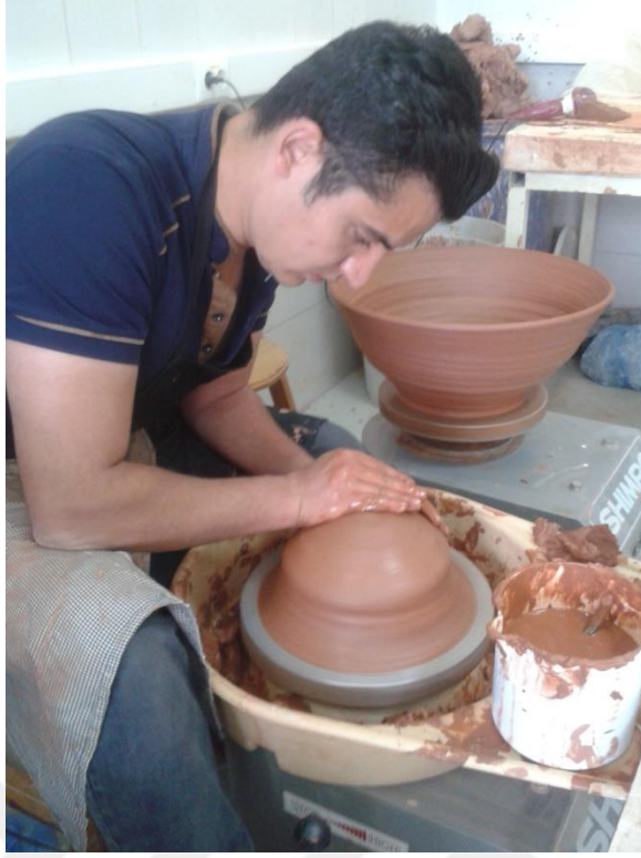
Resim 112: Yoğrulan çamuru tornada merkeze getirme aşaması, Fotoğraf Ahmet M. KILINÇ
