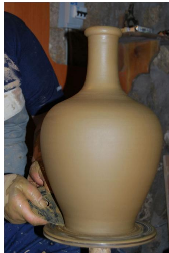
Resim 54: Formun Çeki Tahtasıyla Düzeltilmesi,
