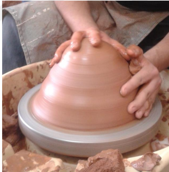
Resim 35: Tornada şekillendirilen çamuru merkeze getirme
