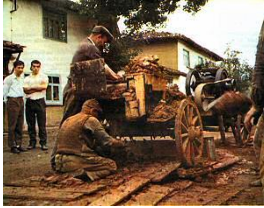
Resim 9: Kınık'ta çamurun iki silindir arasından geçirilişi
