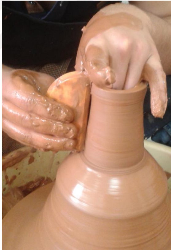
Resim 39: Tornada çekilen formun çeki tahtası ile düzeltilmesi
