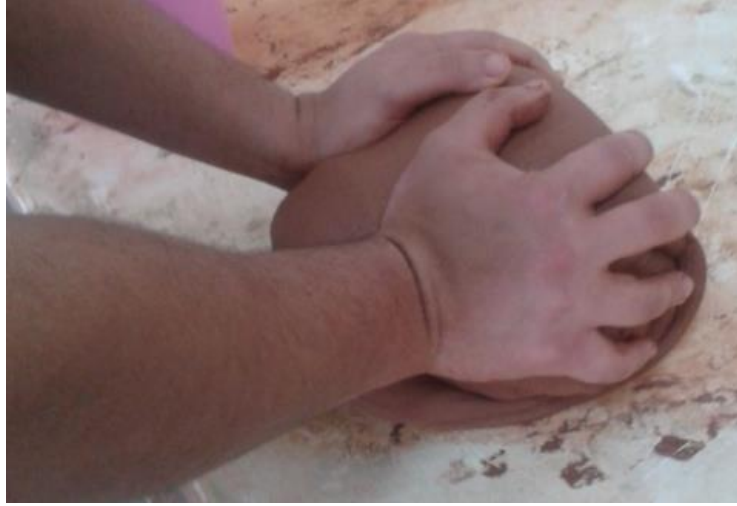
Resim 34: Tornada şekillendirilecek olan çamurun yoğrulması
