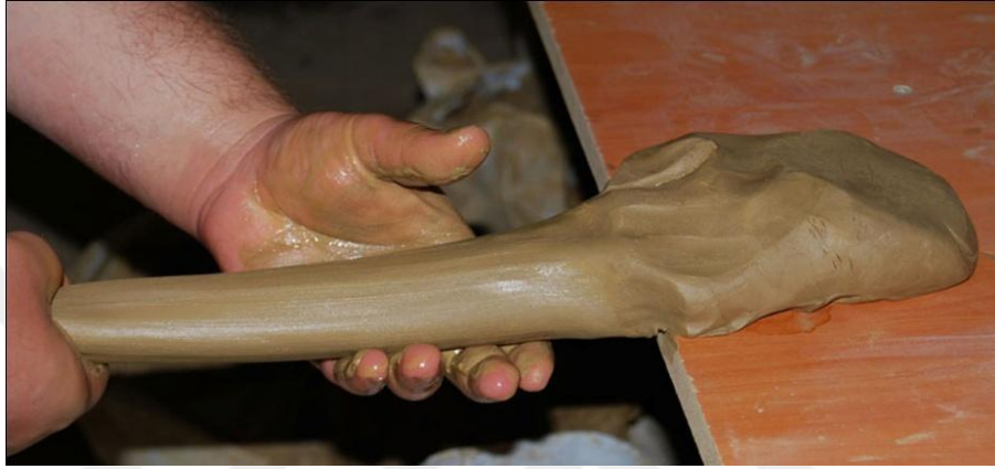
Resim 51: Kulp yapım aşaması Kaynak: Fotoğraf Hakan ÖCEL
