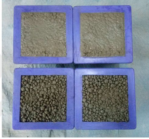
Resim 5. Kp numunelerin yerleřtirme sonrası grnm
