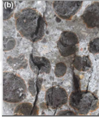
Şekil 6. Basınç dayanımı testinden sonra hafif genleştirilmiş kil agregalı beton numunesinin çatlak deseni (Payam vd., 2014)
