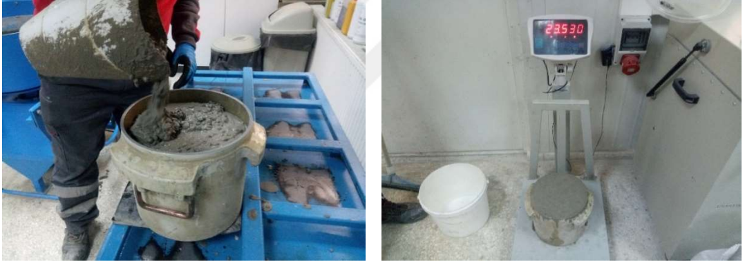
Şekil 16. Betonda hava ölçümü öncesi ve taze birim hacim ağırlık ölçümü
