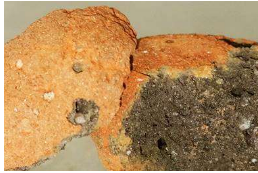
Şekil 2. Hafif, genleştirilmiş kil agregasının iç ve dış görünümü
