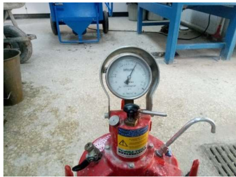
Şekil 16. Betonda hava ölçümü öncesi ve taze birim hacim ağırlık ölçümü
