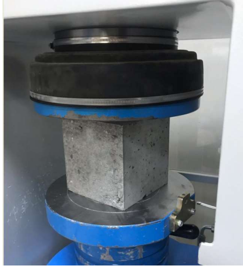
Resim 7. Numunelerin basınç dayanım testi
