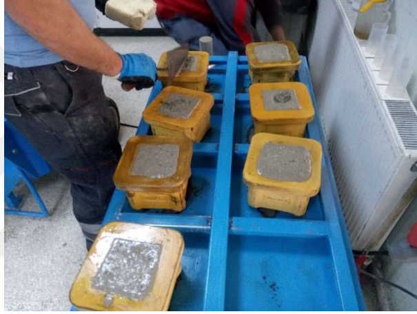
Şekil 14. Taze beton numunesi alımı
