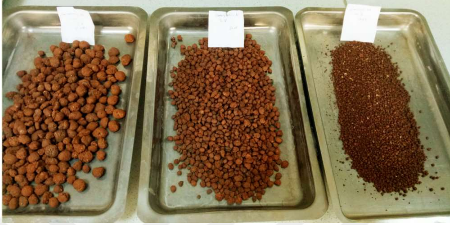
Resim 1. Farklı boyutlarda genişletilmiş kil agregaları
