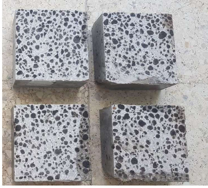
Resim 9. Genleřtirilmiř kil agregalı numune kesiti
