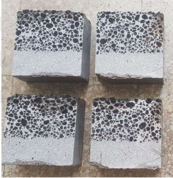
Resim 8. Ayrışan numunelerin kesit görünümü
