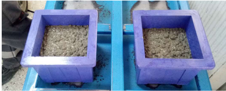
Resim 3. Küp numunelerin alımı
