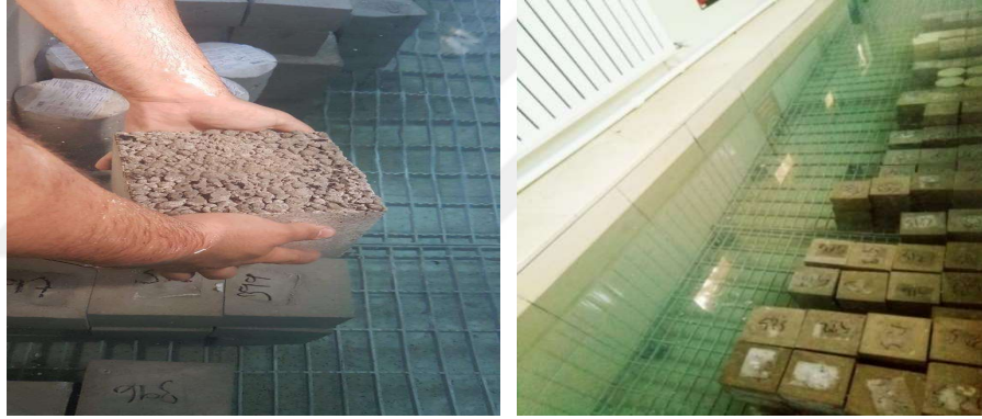
Şekil 18. Kür havuzu ve numunelerin görünümü
