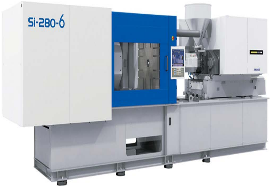
Şekil 27. Tümden Elektrikli Plastik Enjeksiyon Makinesi (Köse, 2006).
