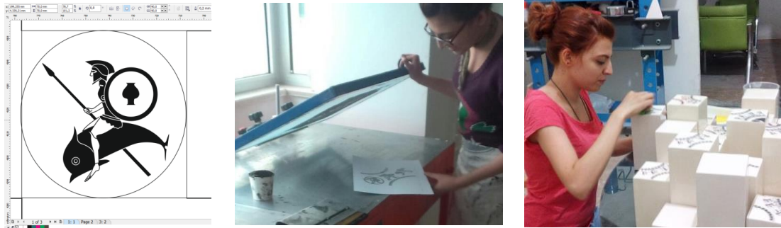
Resim 90; Corel Dekor Çizimi, Çıkarma Baskı ve Seramik Form Yüzeyine Sabitlenmesi.
