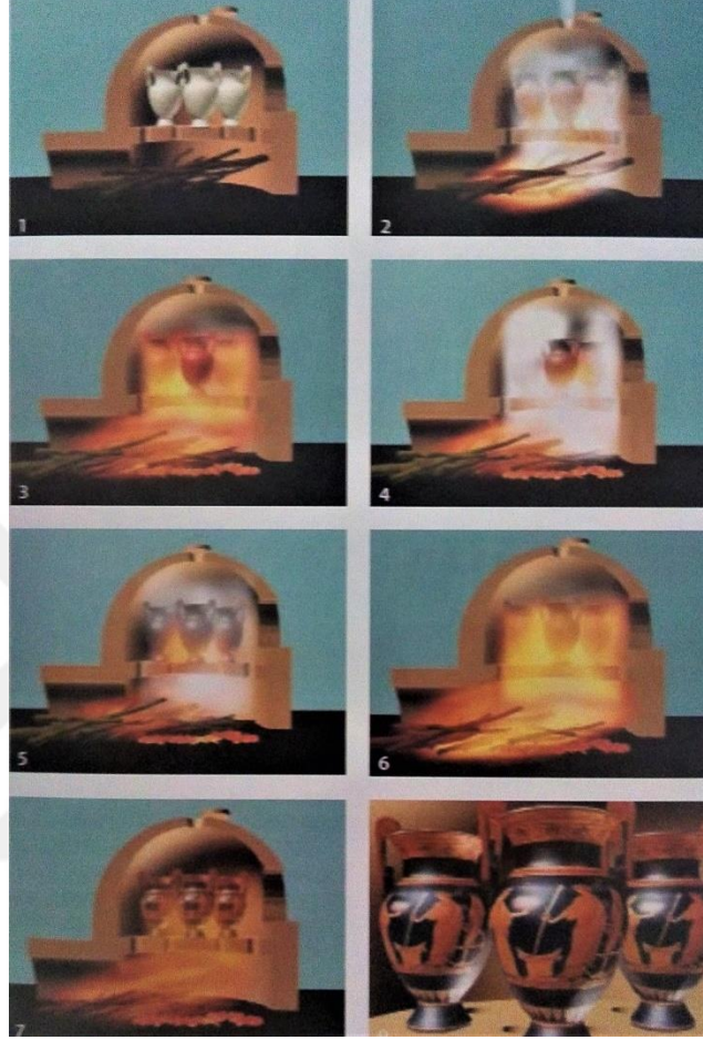
Resim 66; 3D Tasarım: Kamuran Çizer, Tipik Bir Akdeniz Fırınında, Yükseltgen ve İndirgen Periyodlarla Pişirim Sürecini ve Siyah-Kırmızı Figür Kapların Elde Edilmesini Gösteren 3D Tasarım. Kaynak: Sevim Çizer, “Roma Dönemi Galya’ında Terra Sigillata Atölyelerinin Özel Fırınları”, Seramik Pişirim Teknikleri ve Fırınları, Ankara: Opus Basım Evi, 2016, s.55.
