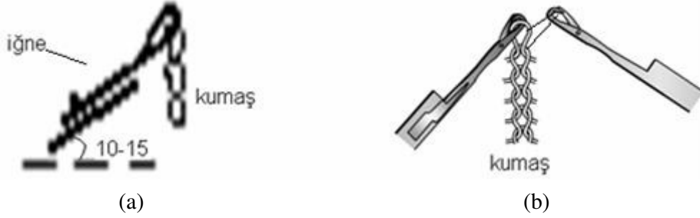
Şekil 1.11. a) Tek iğne yataklı düz örme makinesinin b) V Yataklı düz örme makinesinin iğne yatağının kesiti
