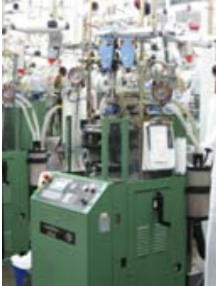
Şekil 1.19. Varis çoraplarının üretiminde kullanılan örme makinesinin fotoğrafı
