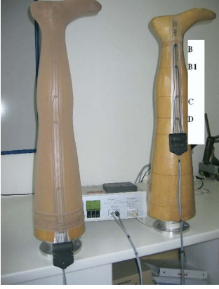
Şekil 1.46. Tıbbi çorap test cihazı (MST) ile ara yüz basıncının ölçümü.
