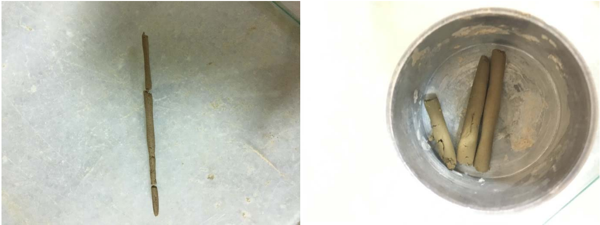
Őekil 18. Plastik limit deneyi sonucunda oluřan atlaklar.
