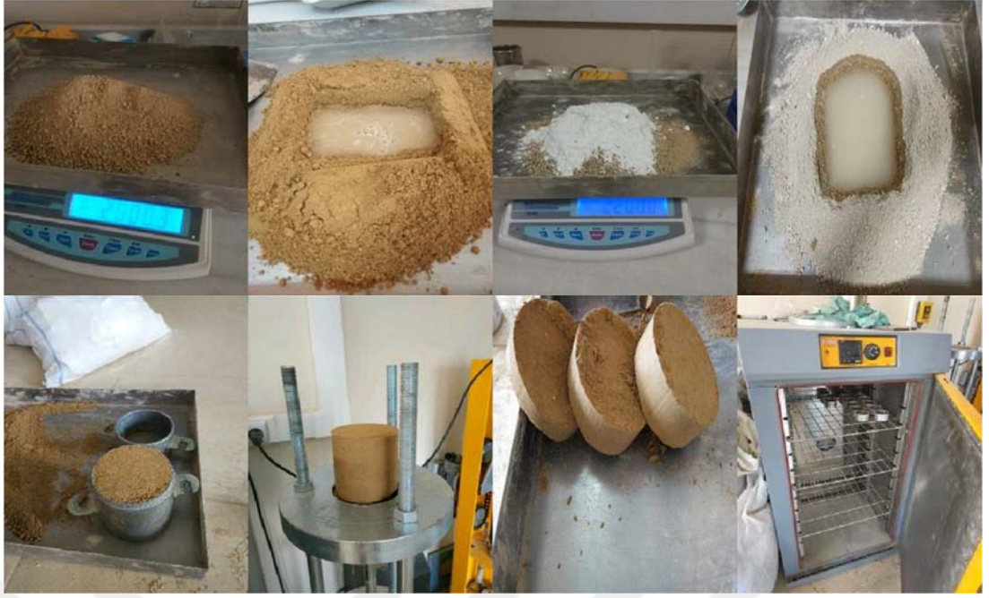
Şekil 19. Standart Proktor Deneyi yapım aşamaları.
