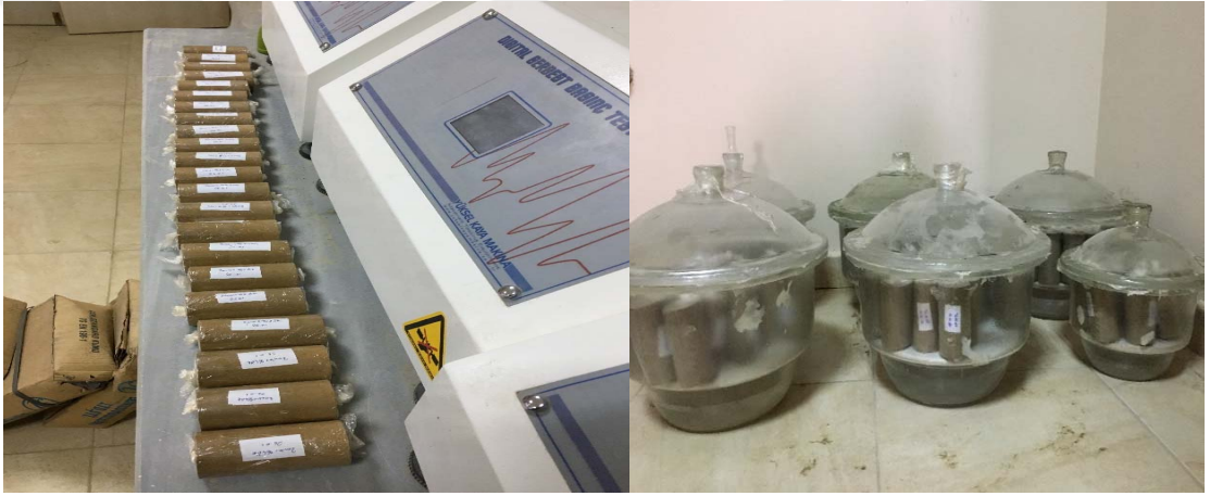
Şekil 33. Numune örnekleri ve desikatörde numunelerin kür edilmesi.
