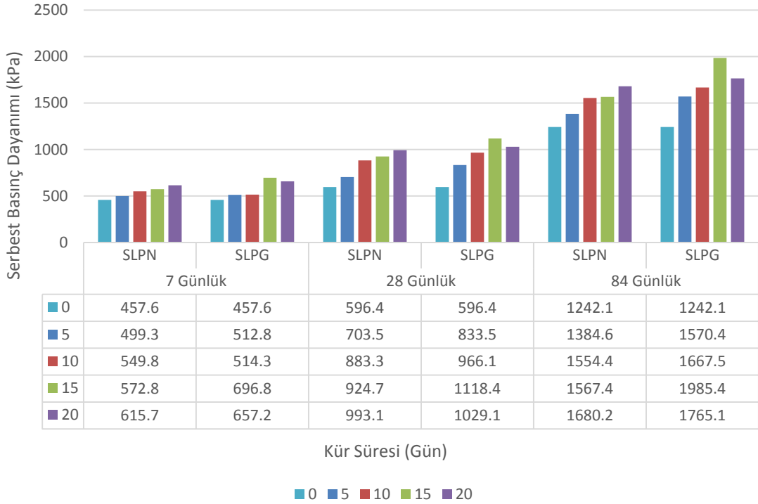
Şekil 39. SPN ve SPG karışımlarının kür sürelerine göre serbest basınç dayanımlarının karşılaştırılması.
