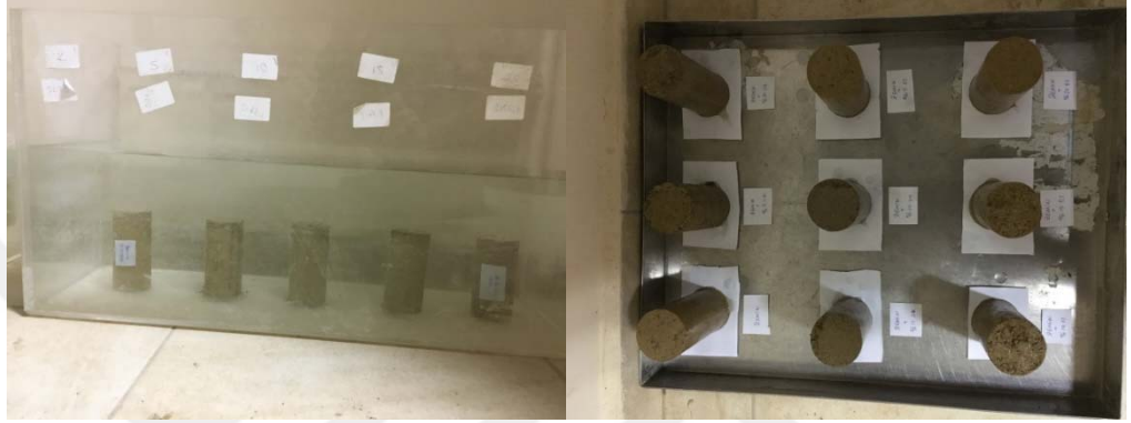
Şekil 21. Islanma-kuruma periyodu deneyi.
