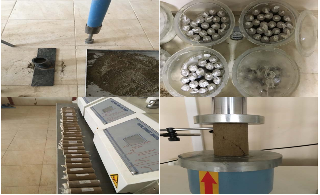
Şekil 20. Tek eksenli basınç deneyine ait düzenek.
