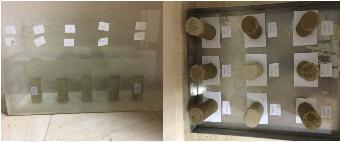
Şekil 41. SLPG ve SLPN numunelerinin ıslanma-kuruma periyoduna ait görüntüsü.
