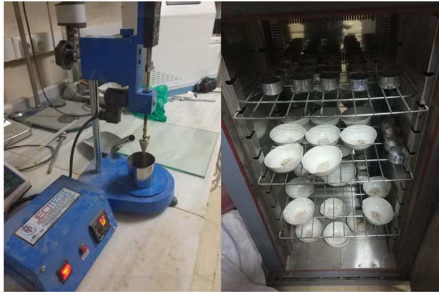
Şekil 17. Koni penetrasyon düzeneği ve etüvde kurutulmuş örnekler .
