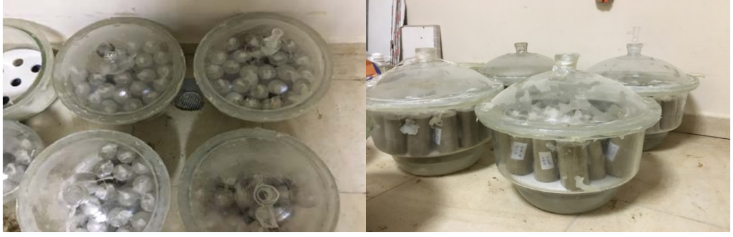
Şekil 25. Numunelerin desikatörde kür edilmesi.
