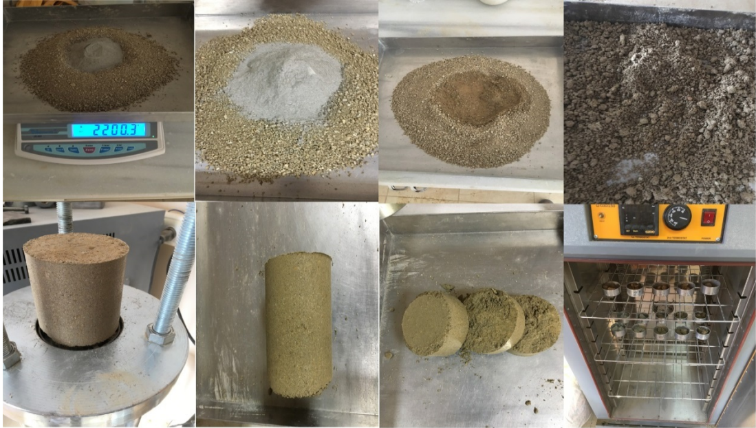
Şekil 11. Standart proktor deneyi yapım aşamaları.
