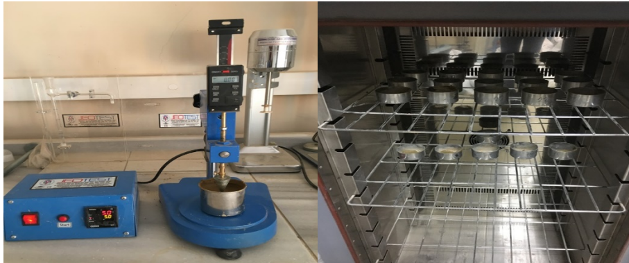
Şekil 10. Koni penetrasyon deney düzeneği ile etüv içerisine bırakılan malzemeler.
