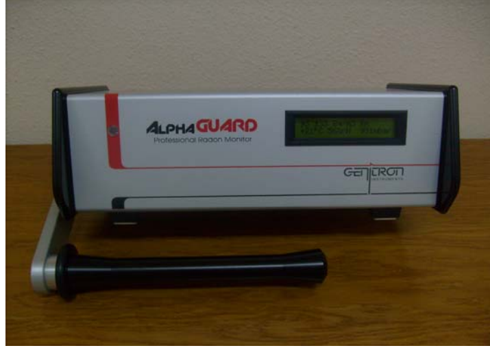
Şekil 3.2 AlphaGUARD PQ 2000PRO dedektörü.
