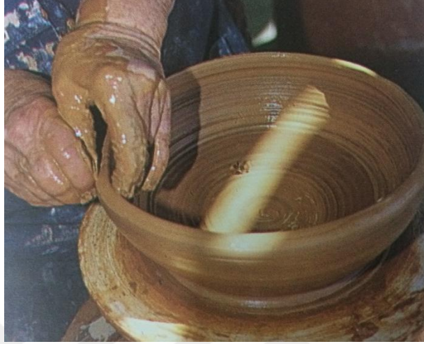
Resim 5: Seramik çamurunu torna ile şekillendirme.
