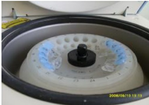
Şekil 3.9. Yıkama solusyonunun uzaklaştırılması amacıyla santrifüjleme
