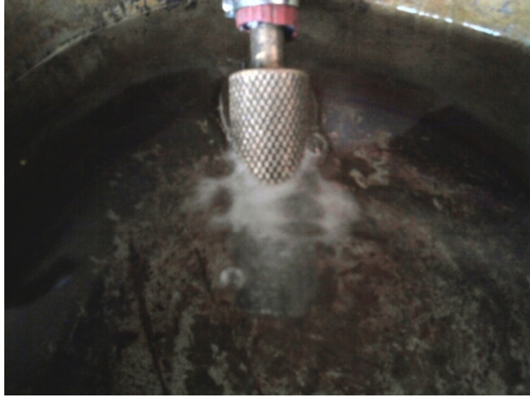
Şekil 4.11 Test burcu aparata geçirilerek su dolu kaba daldırılır
