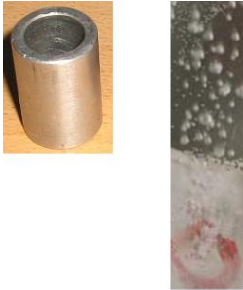
Şekil 4.12 Test burcu ve çıkan hava kabarcıklarının detaylı görüntüsü
