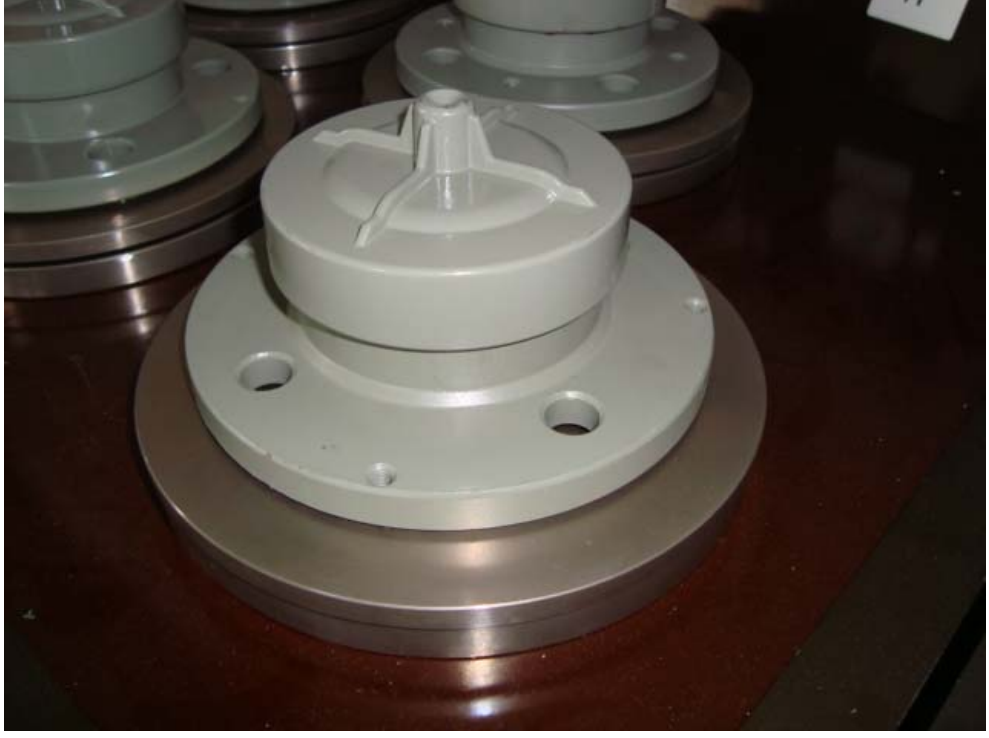
Şekil 3.4 Basınç kontrol valfinin test edilen iç gövdesi
