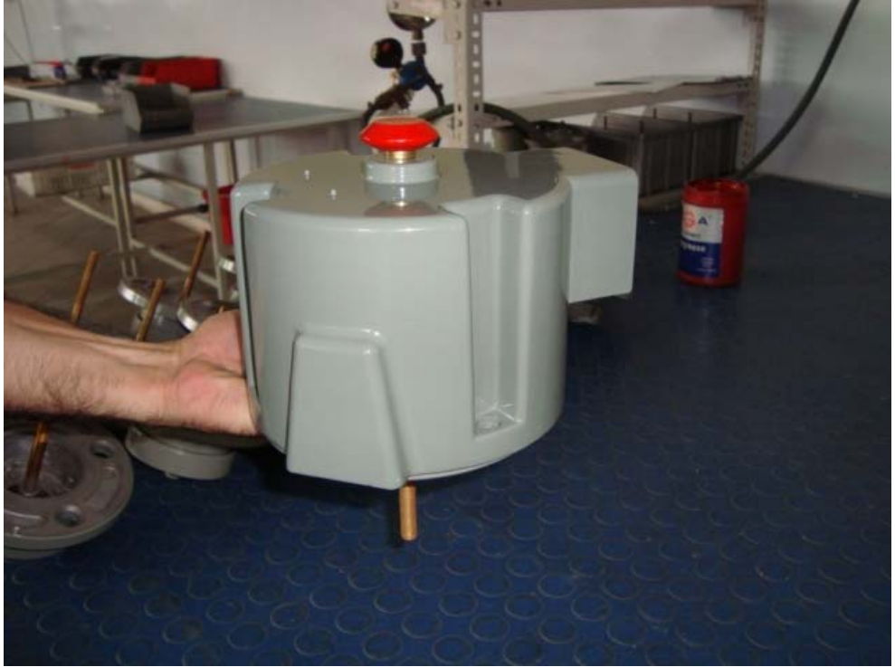
Şekil 3.5 Basınç kontrol valfinin iç gövdesi üzerine testlerden geçtikten sonra geçirilen şapka
