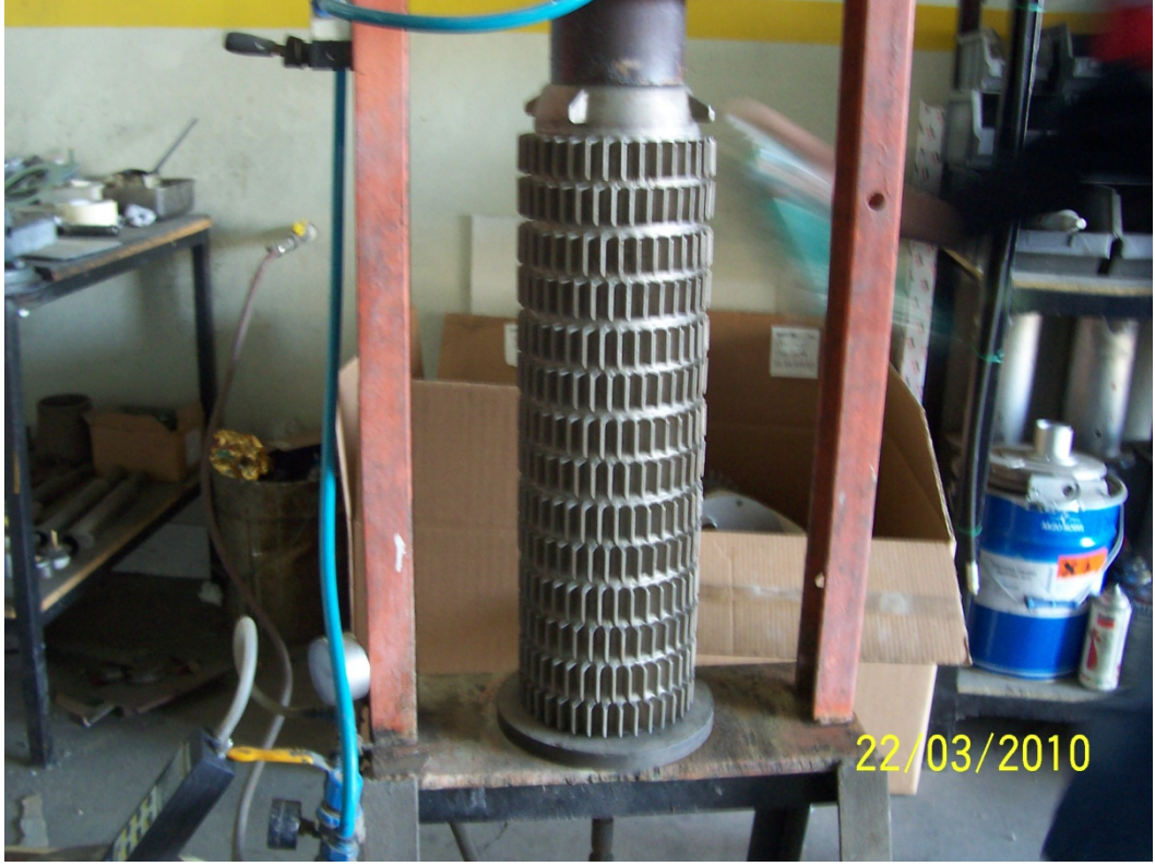
Şekil 4.15 Test standına bağlanan boruya hava verilir ve dijital manometreden bu değer gözlenir
