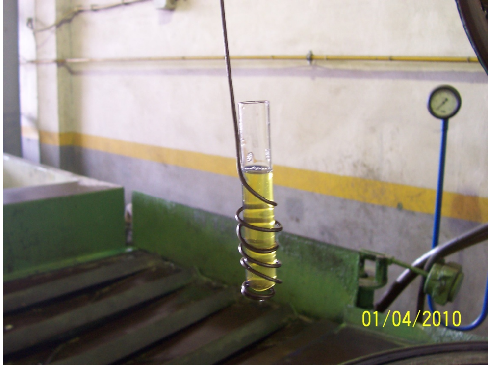
Şekil 4.6 Jelleşme testi için cam tüpe reçine alınır
