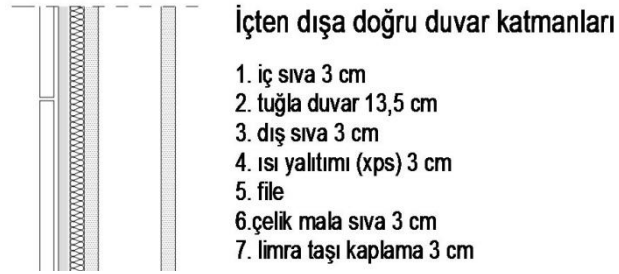
Şekil 3.1 Dış havaya açık duvar katmanları
