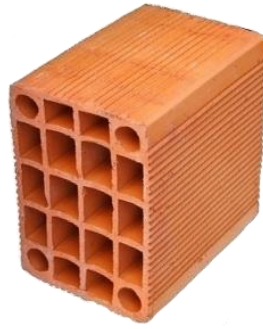
Şekil 2.5. Yatay delikli tuğla (Tukder, 2005)
