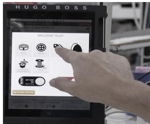
Şekil 14. e-Kanban malzeme talep sistemi (Açıkgöz, 2018)
