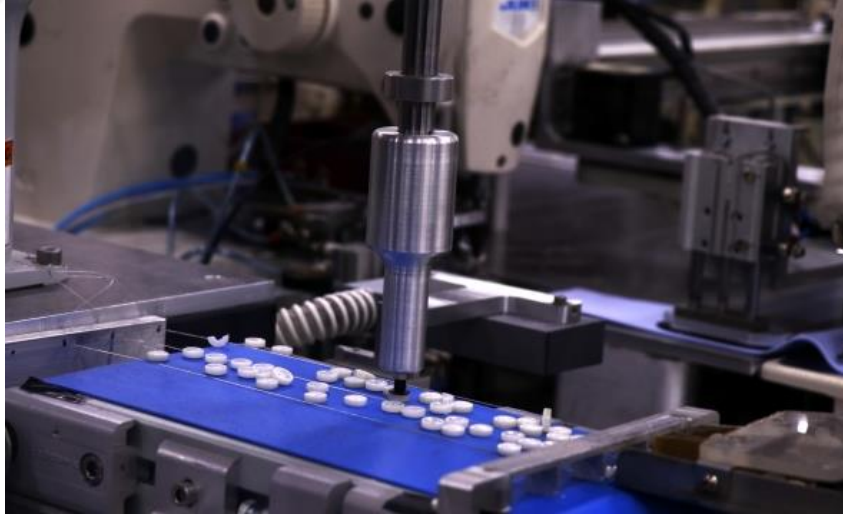
Şekil 18. Görüntü İşleme ile Düğmelerin Doğru Pozisyonda Dikilmesi (Star, 2017)
