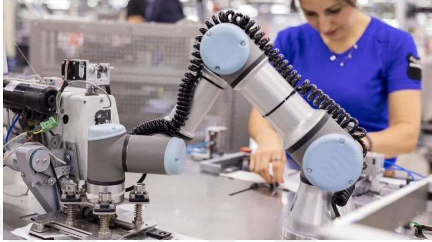
Şekil 17. Robotik Uygulama Örneği (Parçaların Birlikte Dikilmesi) (Hugo Boss, 2018)
