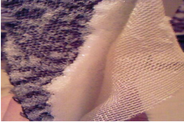
Şekil 2.5. Üç bileşenli otomotiv döşemelik kumaş yapısı
