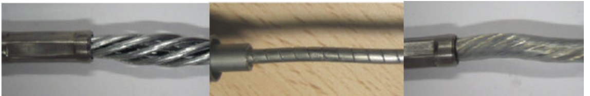
Şekil 6.1: Test sonrası burkulma oluşan iç kablo örnekleri Kaynak: Technical dossier for shifter cables, Ficosa 2010
