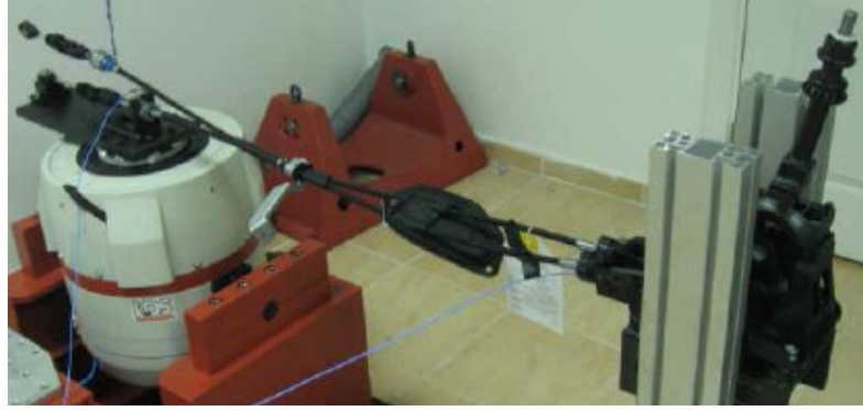
Şekil 6.6: Vites kablosunun titreşim büyüklüğü ölçümü Kaynak: Cable vibration magnification report, Ficosa Otomotiv 2010
