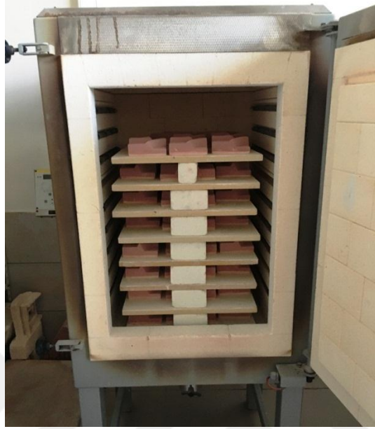
Resim 95: Sırlı ürünlerin kamara fırına yerleştirilmesi Fotoğraf: Meltem Çinpolat
