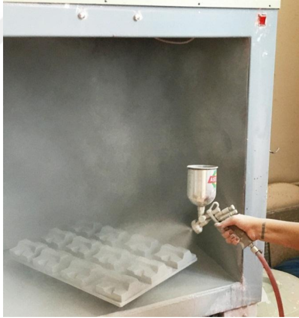
Resim 94: Püskürtme yöntemi ile seramik modüllerin sırlanması Fotoğraf: Mediha Alkan
