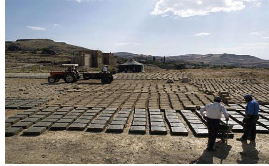
Resim 40: Kalıptan çıkarılan kerpiçler http://www.isbs2015.gazi.edu.tr/belgeler/bildiriler/184-192.pdf (30.04.2019)
