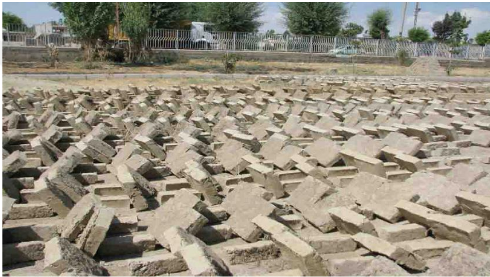
Resim 41: Kalıplarından çıkarılan kerpiçin çapraz dizilimle tüm yüzeylerinin kurutulması http://www.isbs2015.gazi.edu.tr/belgeler/bildiriler/184-192.pdf (30.04.2019)
