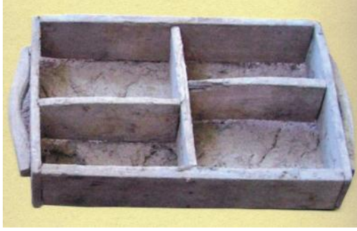
Resim 39: Dört gözlü ahşap kerpiç kalıbı http://www.isbs2015.gazi.edu.tr/belgeler/bildiriler/184-192.pdf (30.04.2019)
