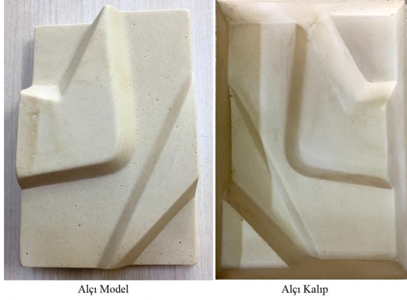
Resim 85: Tasarım (5) alçı model ve kalıbı Fotograf: Meltem Çinpolat
