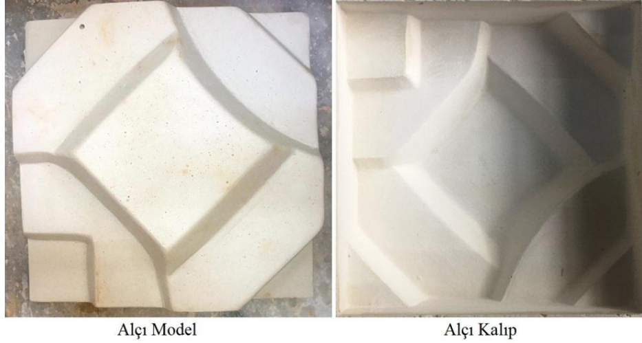
Resim 83: Tasarım (2) alçı model ve kalıbı Fotoğraf: Meltem Çinpolat
