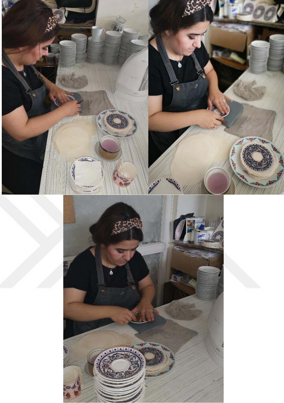
Resim 57: Çıkartma Yöntemi ile Serigrafî Uygulama (Kütahya Çini)
