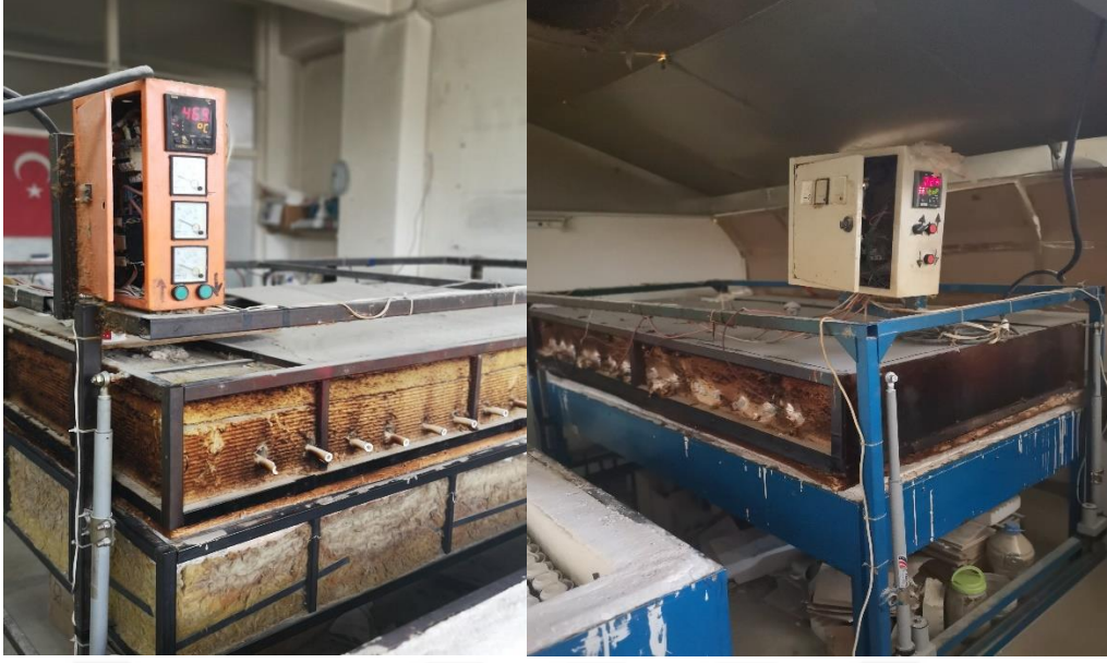
Resim 61: Çıkartma Yöntemi ile Yapılmış olan Ürünlerin Fırınlama Aşaması
