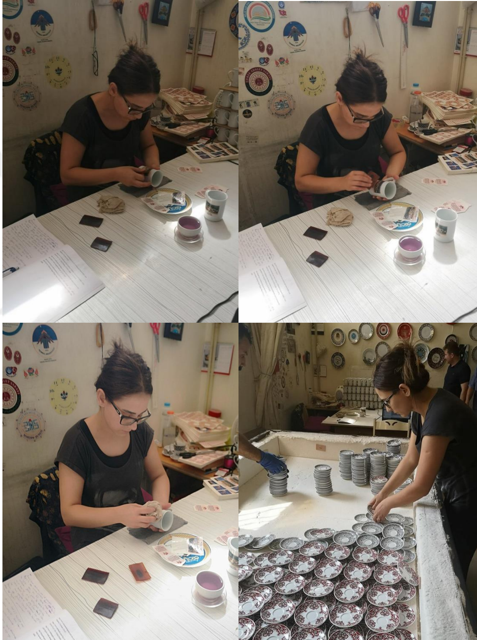
Resim 69: KİŞGEM (Kadın İş Geliştirme Merkezi) de Serigrafi çıkartma tekniğini sırlı düz yüzey bardak formlarında uygulama çalışmaları
