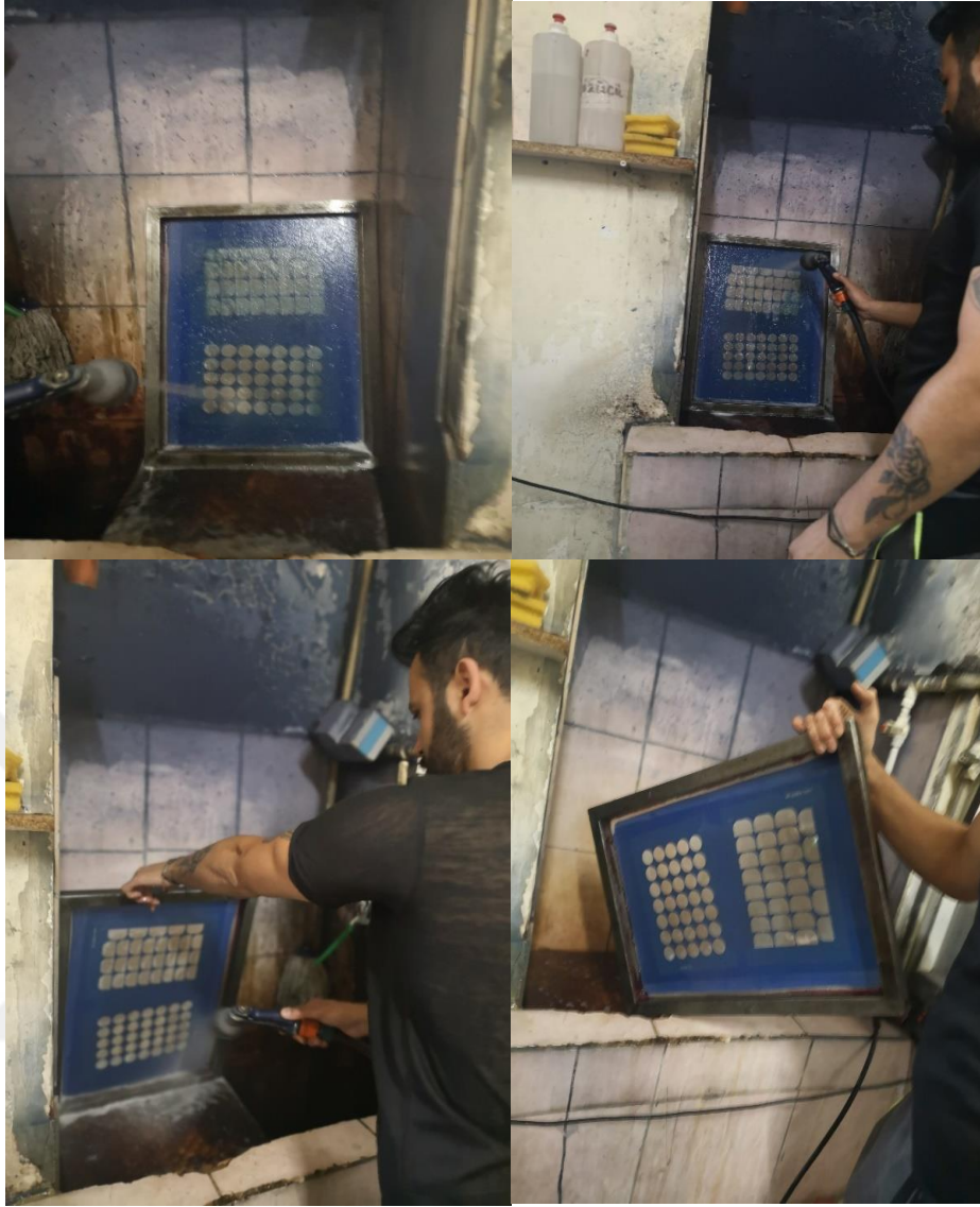
Resim 29: Baskı İşleminde sonra Elekların Özel Yıkama Kabininde Temizliğinin Yapılma İşlemi.
