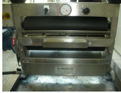
Şekil 3.2. W.Mathis AG fulard makinesi
