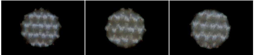
Şekil 4.22. Kloroform ve triklorasetikasit ile sırasıyla 1dk, 5 dk ve 10 dk süreyle bzdürme yapılmış ön fiksesiz 96 filamana sahip kumaşların mikroskop görüntüleri
