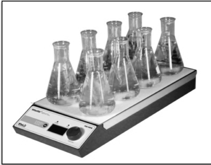
Şekil 3.1. Fenton deneylerinin yapıldığı manyetik karıştırıcı.
