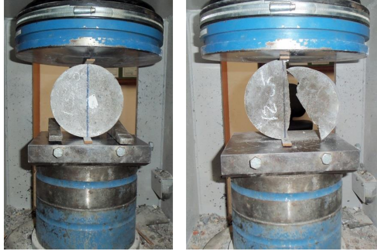
Şekil 3.16. Yarma çekme deneyi
