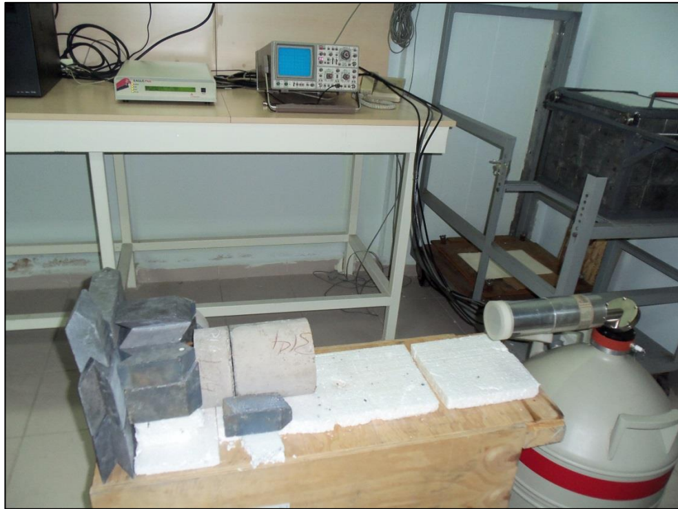
Şekil 3.21. Radyasyon geçirimsizlik deney düzeneği
