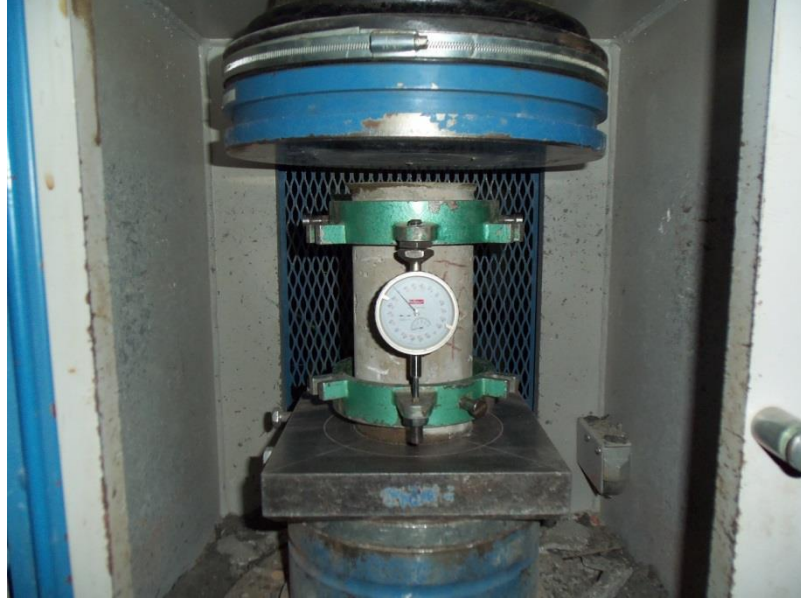
Şekil 3.14. Elastisite modülünün tespit edilmesi
